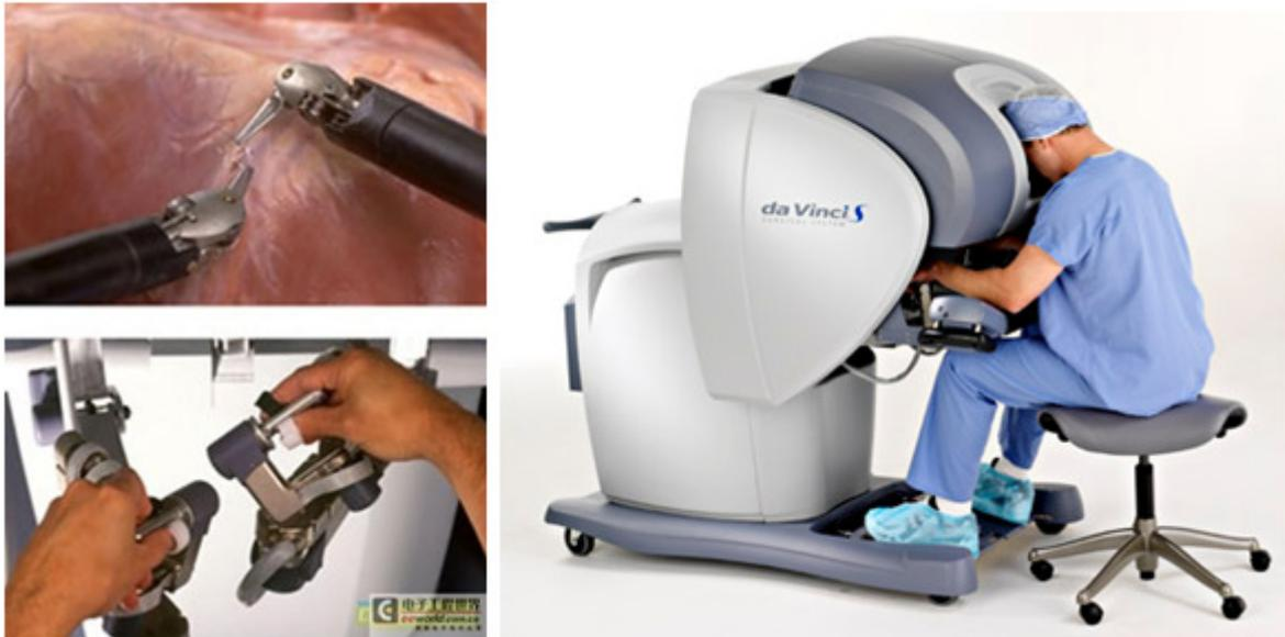
Figura 1.8 Console ergonomica del Da Vinci (destra); Master controller attuati dal chirurgo e corrispondente movimento degli strumenti robotici (sinistra)
