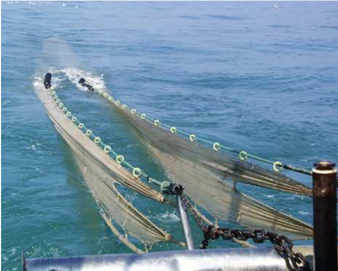
Fig. 2.2 - Rete da pesca a strascico di fondo.
