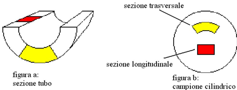
Fig.2.8 - Preparazione dei provini per l'osservazione al microscopio metallografico.
