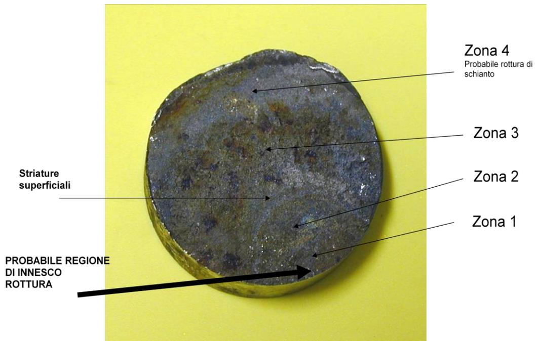
Fig. 3.5 - Superficie di fratture del perno A.
