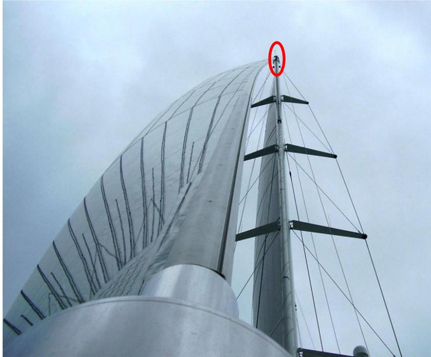
*Fig.2.2 – Perno di Backstay dell'albero di maestra.*
