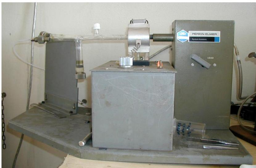
Fig.2.12 - Desorbimento termico ad alta T.
