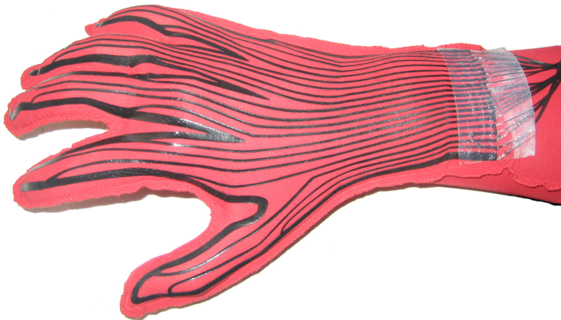
Figura 13: Il guanto sensorizzato del Centro Piaggio, con le piste di elastomero in evidenza (in nero).
