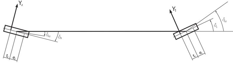
**Figura 3.1:** Modello monotraccia con sistema di sterzo cedevole
