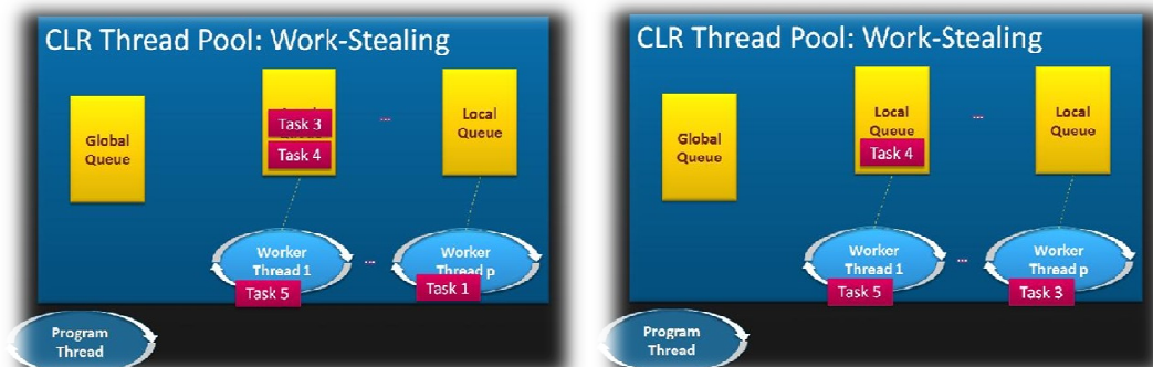
Figura 5.9, il worker thread 1 termina il proprio lavoro e preleva il primo task accodato (sinistra); il worker thread p termina il proprio lavoro e preleva l'ultimo task accodato nella coda del worker thread 1 (destra)
