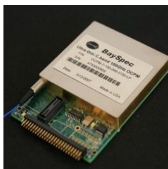
Figura 2.14: Il Wave Capture FBG Interrogation Analyzer della BAYSPEC
