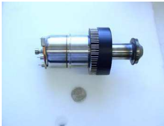
Fig. 2.14 - Convertitore Sunpower da 35 We di ultima generazione, [10]
