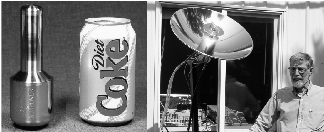
Fig. 2.31 - Mini convertitore ermetico Sunpower da 35 We (a sinistra), e integrato in un generatore solare portatile con William Beale, inventore degli FPSE (a destra),[22]
