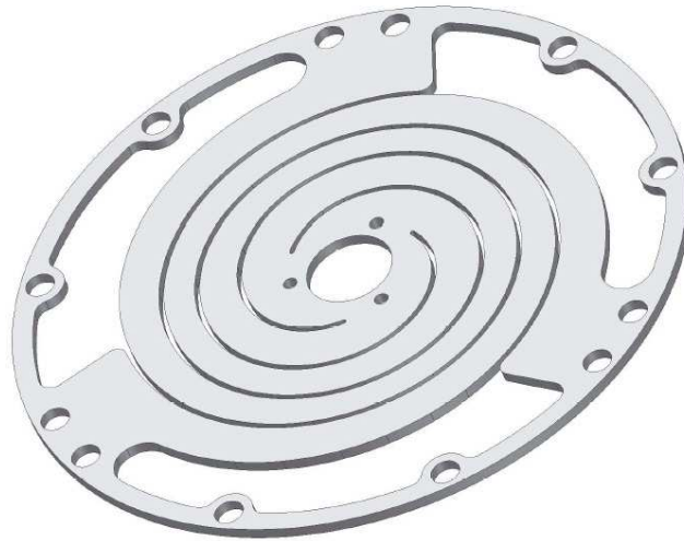
Fig. 2.26 - Design delle molle planari montate sul TDC,[16]
