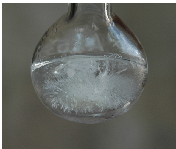
Cristalli aghiformi di albumina nella soluzione 0,4 % in \text{D}_2\text{O} conservata in frigorifero
