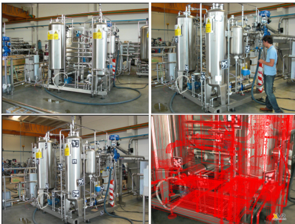
Figura 1: Applicazione di markers ad un macchinario industriale e relativa sovrapposizione del modello CAD
