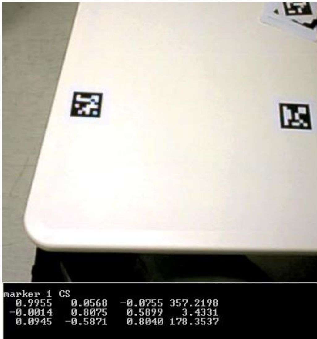
Figura 4.1: Problema nel calcolo della matrice di trasformazione relativa tra due markers
