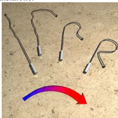
Fig. 1.1.4: Comportamento di un filamento di metallo a memoria di forma all'aumentare della temperatura [ 4 ]
