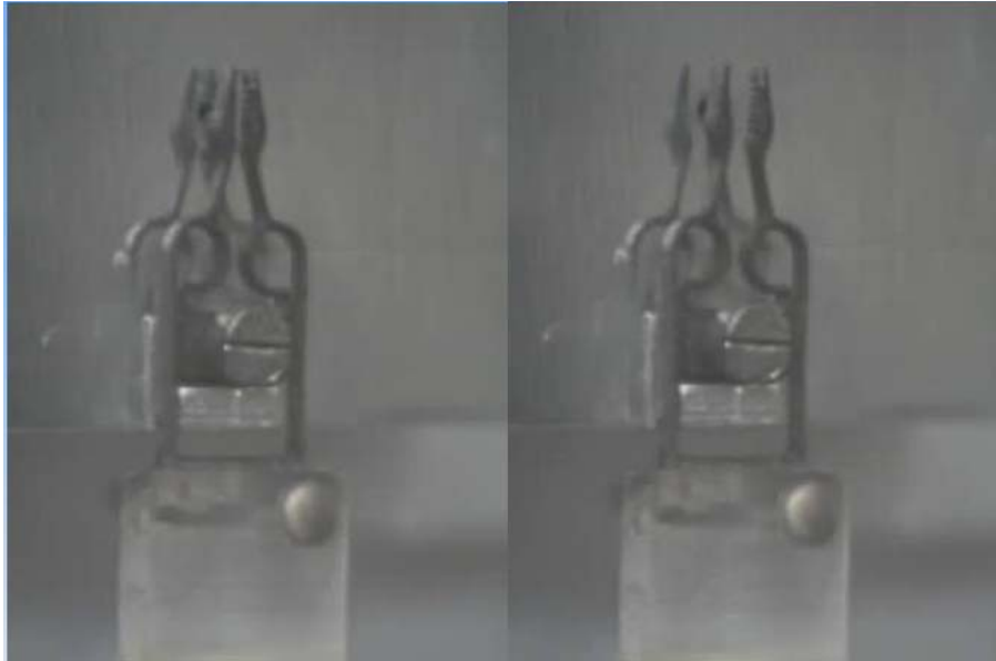
Fig. 1.2.8: Microgripper nella configurazione in deformata (a sinistra) e deformata (a destra). Si noti in particolare l'apertura delle dita nella foto di destra.
