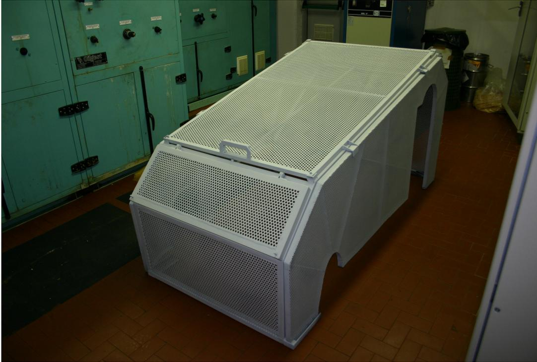
*Foto 20: gabbia completa smontata dalla macchina. Portelle laterali bloccate in questa posizione*
