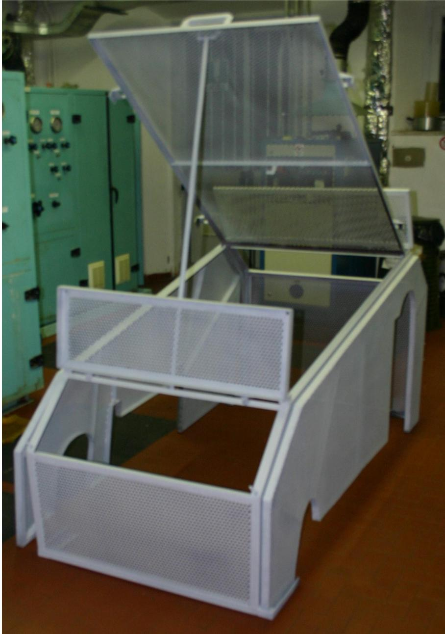
*Foto 21: Gabbia di protezione con le portelle superiori aperte: in questa posizione sono estraibili le portelle laterali*
