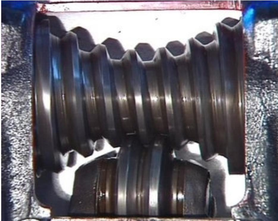
*Foto 6: sterzo automobilistico a vite globoidale e rullo*
