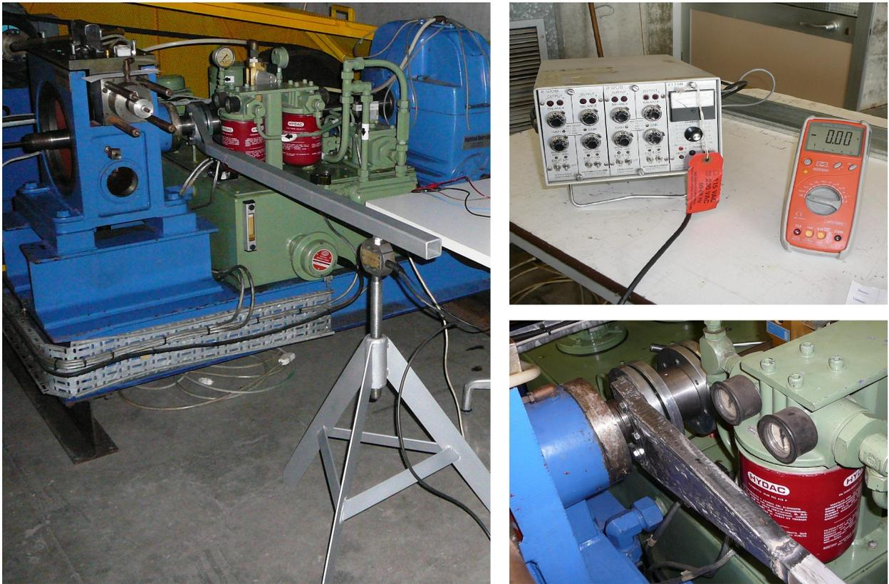
*Foto 25: Braccio di carico e strumentazione per la taratura del ponte estensimetrico*
