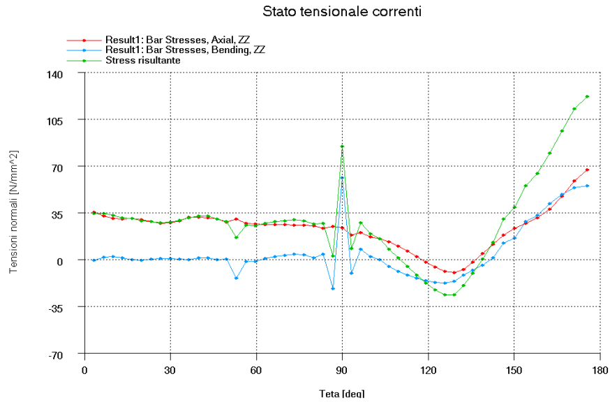
Figura B.9: stato tensionale complessivo dei correnti, caso di pressurizzazione ultima
