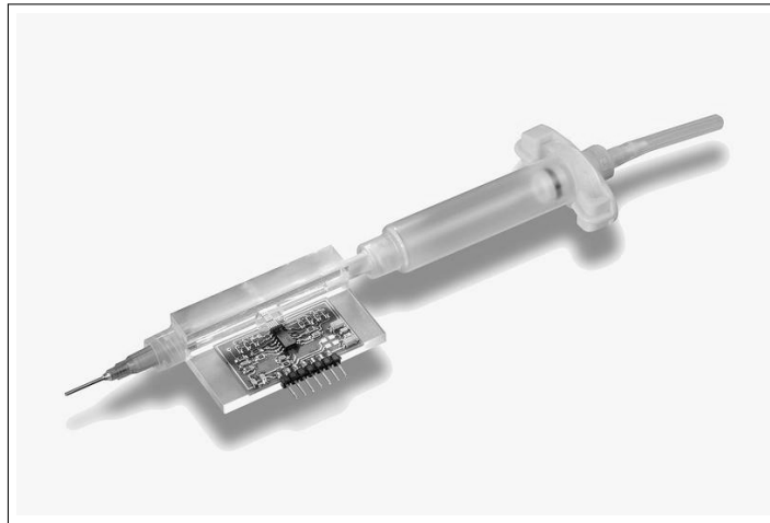
FIGURA 17. Fotografia del dispositivo prodotto da HSG-IMIT completo di package per il dosaggio di piccolissime quantità di fluido (ordine dei nanolitri).
