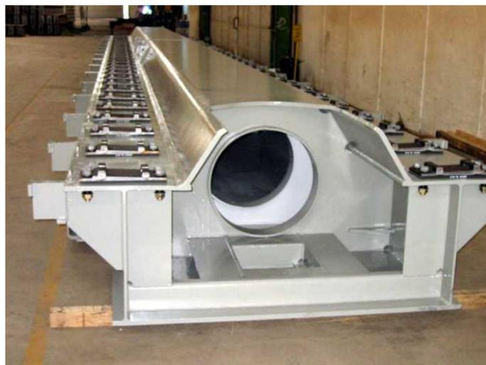
*Fig. 4.25 Ponte Bologna con piastre di armamento*
