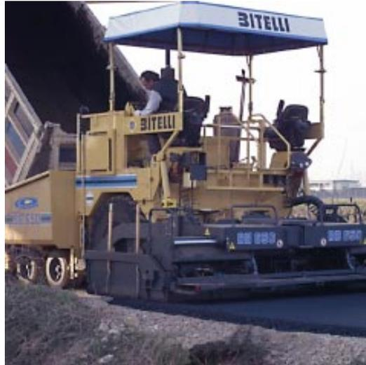
*Fig. 6.24 Macchina asfaltatrice*
