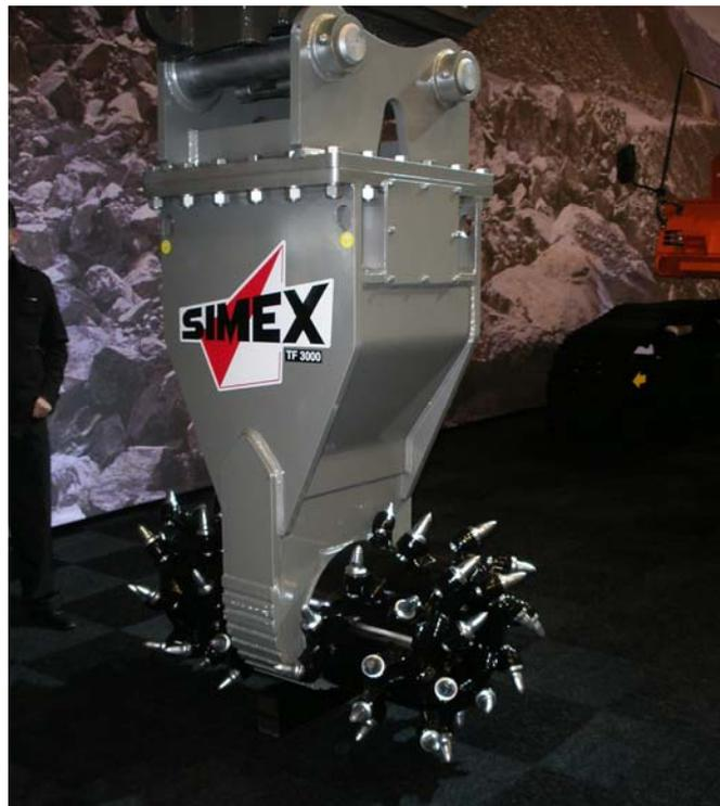
*Fig. 6.5 Fresa demolitrice*
