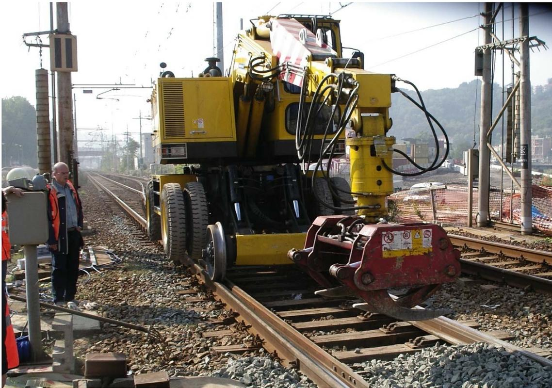
*Fig. 6.17 Caricatore ferroviario con pinza. Si nota chiaramente il sistema di trazione su gomma e su rotaia*
