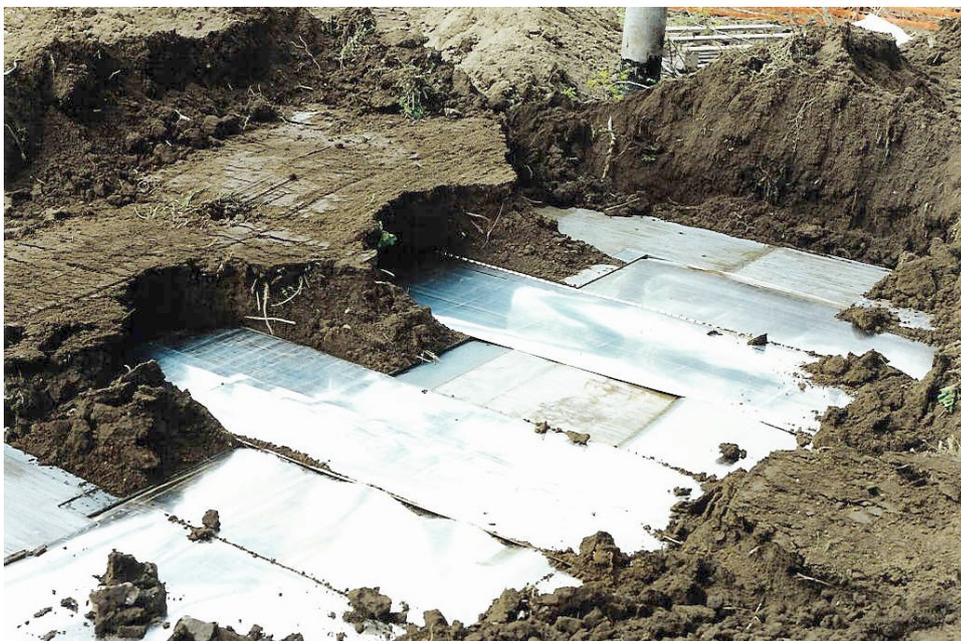
*Fig. 4.54 Distacco per trascinamento della parte anteriore del contrasto, a sinistra, che si viene a trovare sulla parte di scudo non coperta dai nastri*
