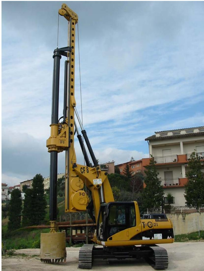
*Fig. 6.15 Macchina per la realizzazione di pali*
