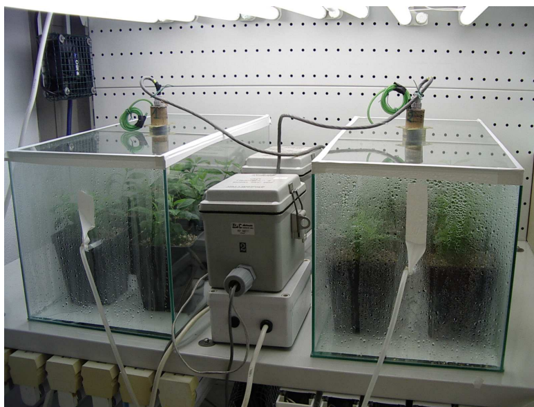
Fig. 17 – Celle utilizzate per sottoporre le piante di Mr.S. 2/5 a due diverse concentrazioni di CO 2 atmosferica.
