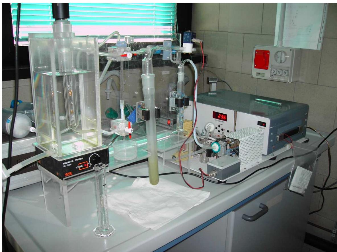
Fig 2.7: Spettrofotometro ad assorbimento atomico
