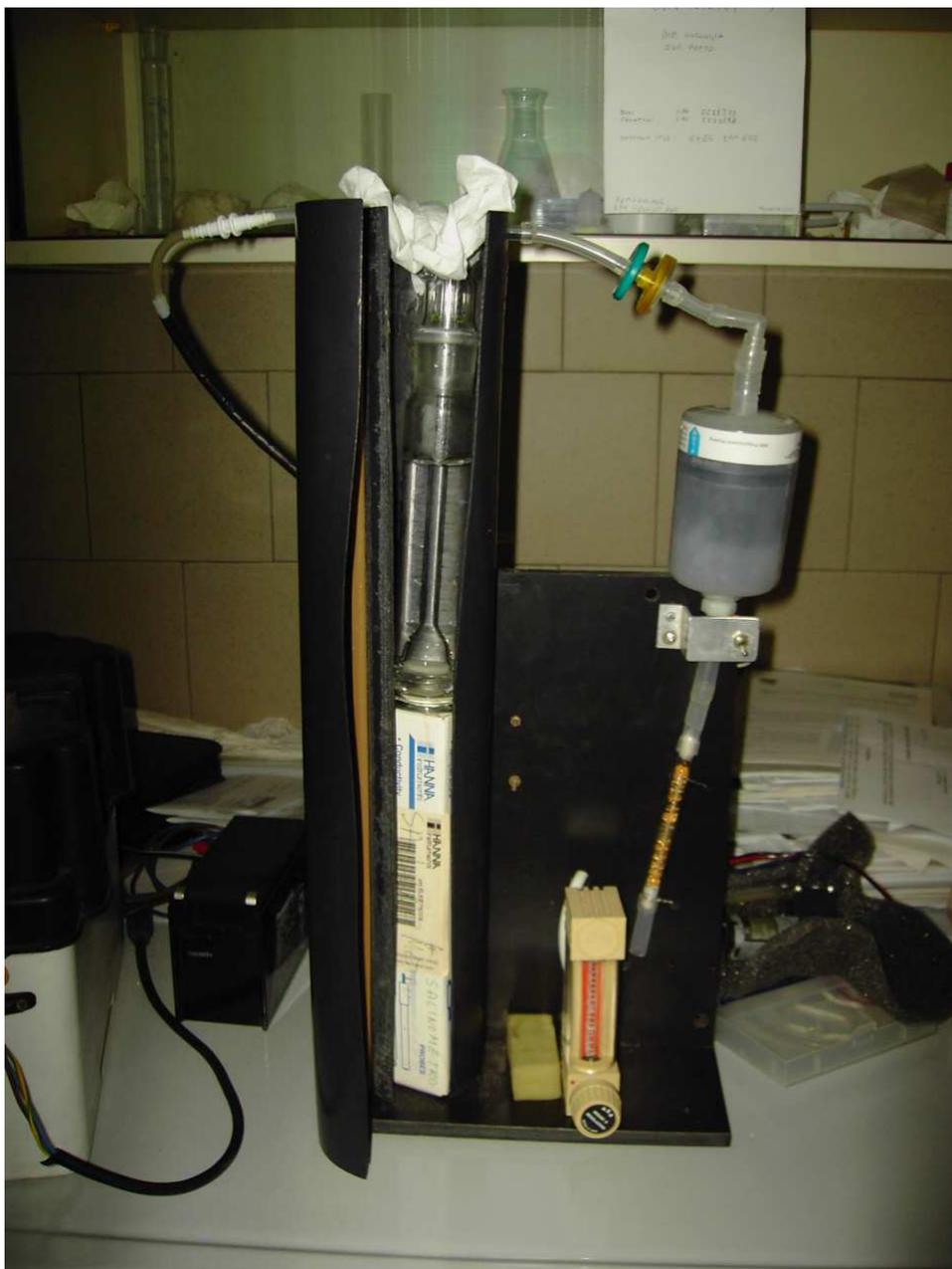
Fig 2.6: Dispositivo utilizzato per le misure di produzione di DGM
