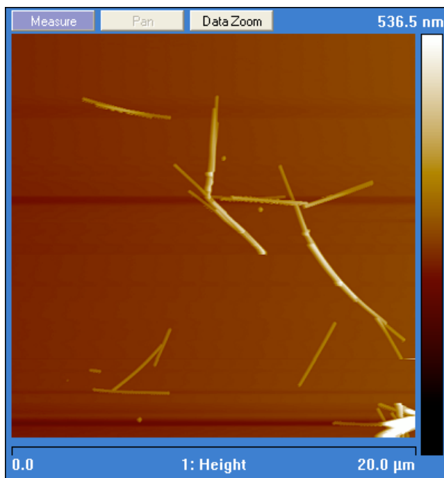
Figura 3.9: Deposizione a secco di un gruppo di nanofili sul substrato di SiO_2 . Immagine topografica ottenuta mediante AFM.
