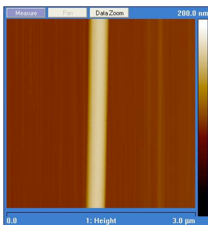
Figura 5.19: Immagine topografica del nanofilo (tracciando sempre la stessa linea di scansione, cioè a y fissato), utile per identificare la posizione dell’oggetto lungo x nelle immagini di KPM successive.
