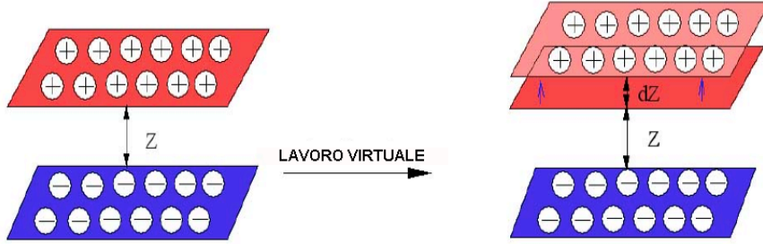
Figura 2.13: Principio del lavoro virtuale: condensatore a facce piane e parallele.
