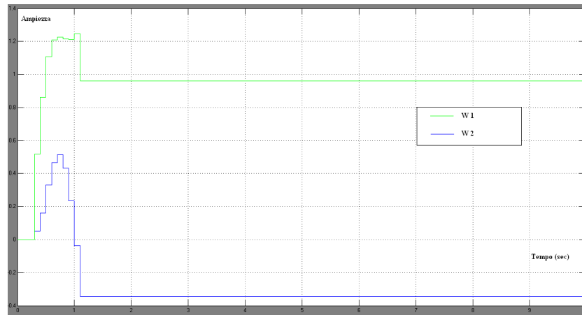
Figura 3.17: Forzatura del vettore w ad un secondo alla comparsa del target. I valori degli elementi del vettore sono: -0.3442 e 0.9602 .
