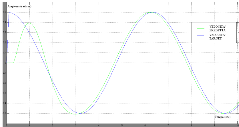
Figura 3.10: In figura si mostra il confronto tra la velocità del target e la velocità in uscita dal predittore che risulta essere in anticipo dopo un breve transitorio.
