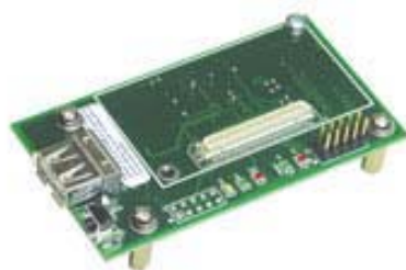
Figura 6. Il supporto MIB520 che consente di interfacciare un nodo della rete alla seriale di un PC
