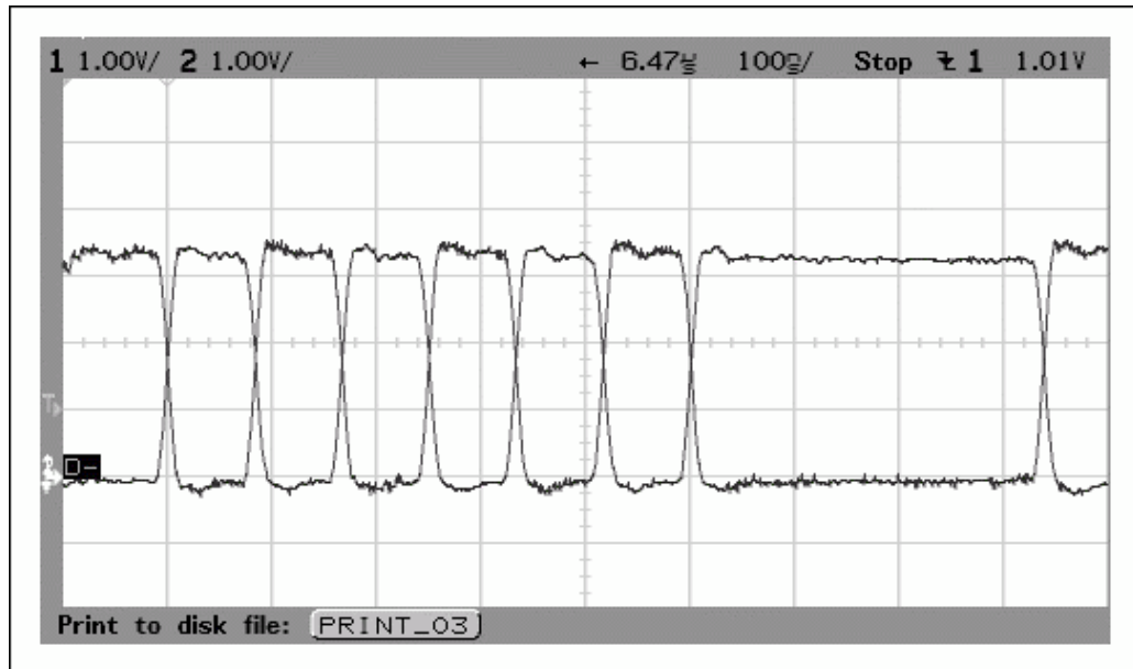
Figura 3.6: Andamento dei segnali D+, D- nel tempo durante l'invio del pacchetto SYNC. Da questa immagine è possibile verificare i livelli di tensione (circa 3,3V) e la durata di ogni bit trasmesso, circa 83ns (1/12MHz).
