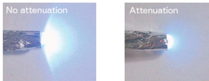
Figura 5.15: Esempi di impulsi LED utilizzati per la calibrazione dei guadagni dei fototubi del calorimetro finale, con e senza attenuazione. Si noti la maggior uniformità della luce emessa in presenza di attenuazione.
