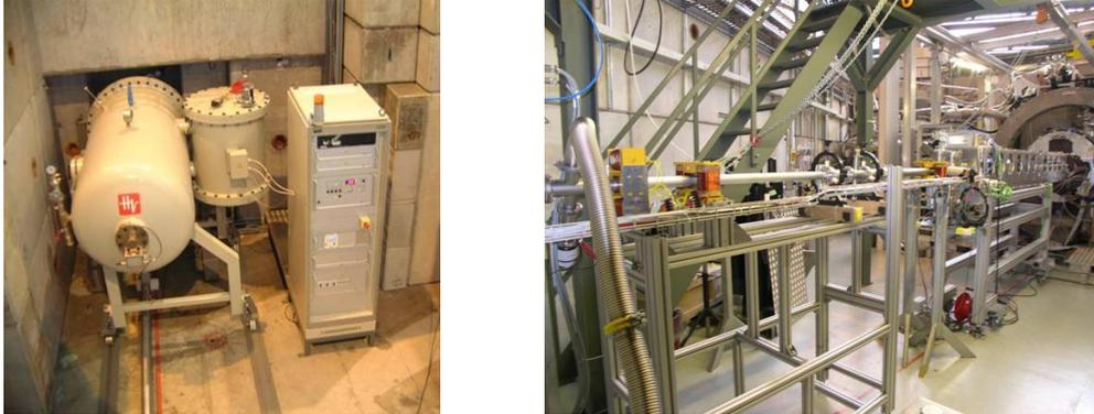
Figura 5.19: A sinistra: collocazione dell’acceleratore C-W all’interno dell’area sperimentale. A destra: linea di fascio per il trasporto dei protoni fino al centro di COBRA; il fascio di muoni è situato in posizione opposta rispetto al magnete.
