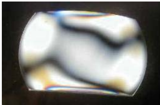
Fig. 3.4 - Esempio di fenomeno di birifrangenza in un componente ottico.
