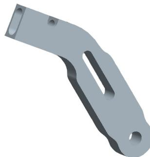
Figura 3.45: Disegno del portazampe ottenuto col software PRO-E
