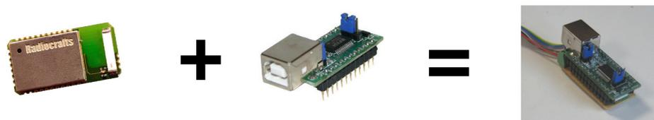
Figura 4.19: I componenti del dongle
