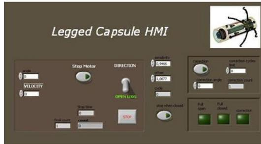
Figura 3.36: HMI per il controllo della capsula a 4 zampe
