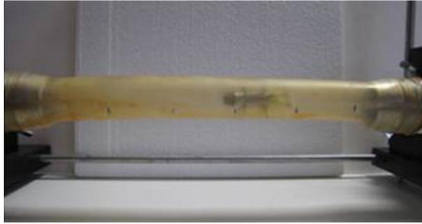
Figura 5.4: Banco di prova con tubo di lattice
