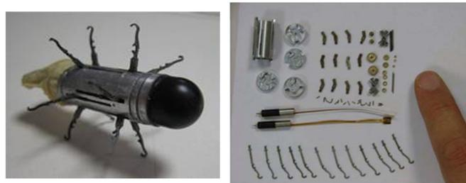
Figura 3.42: Fotografia della capsula endoscopica a 12 zampe e dei suoi componenti
