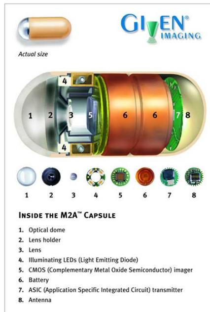
Figura 3.14: La capsula endoscopica passiva M2A
