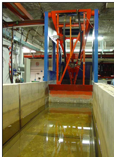
Figura 2-7: Prospetto frontale della parte meccanica del generatore di onde del Laboratorio Costiero di Firenze.
