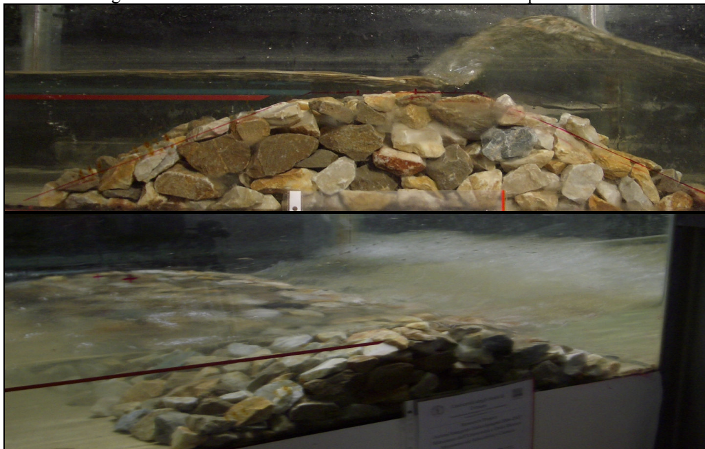
Figura 4-7: Esempio di interazione onda-struttura (terza sessione di esperimenti).
