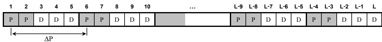
Fig.3.1.1 – Struttura del Burst con Pattern (2,5).
