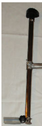
Fig5.18: elemento per posizionamento sonda
