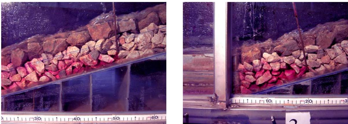
Figura 6.28 tracciante prova n°105 sezione  $x=50\text{cm}$  e  $x=80\text{cm}$
