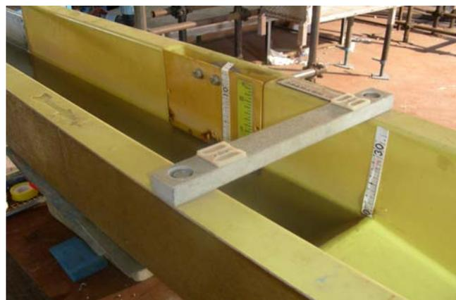
Figura 4.15 dettaglio dell'asta graduata per le letture di misura del livello
