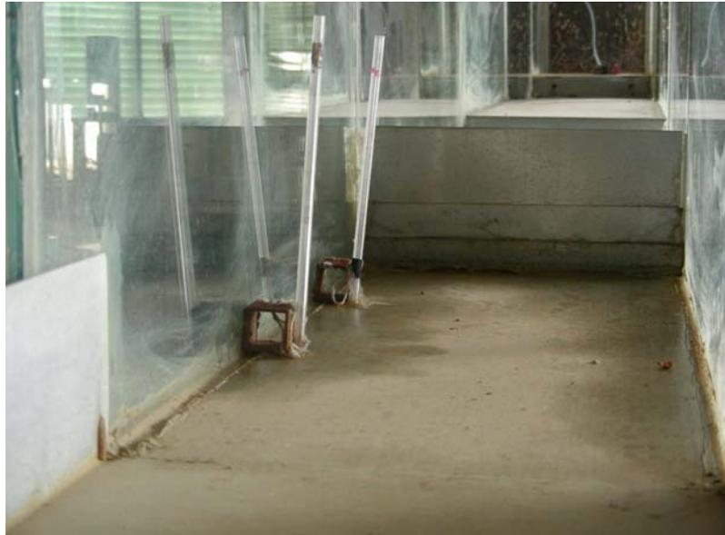
Figura 4.10 piezometri di valle per la regolazione della pressione
