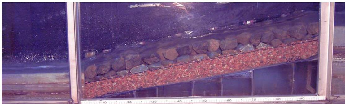
Figura 4.33 materiale di base M2, strato superficiale B1-B6, (prova n°91)
