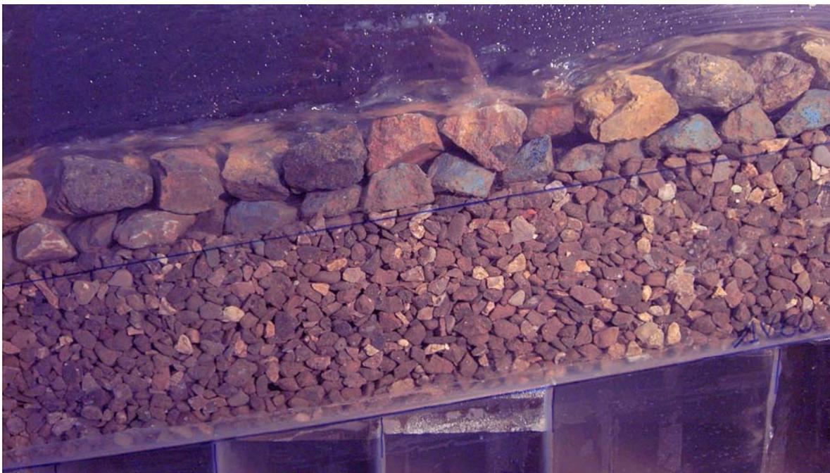
Figura 4.27 materiale di base M1, strato superficiale B1-B6,  $Q=4\text{l/s}$  (prova n°75)
