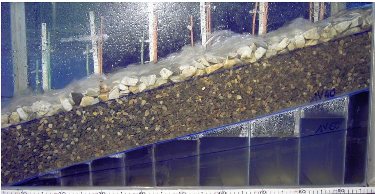
Figura 4.30 materiale di base M8, strato superficiale B2-B2,  $Q=4\text{l/s}$  (prova n°34)
