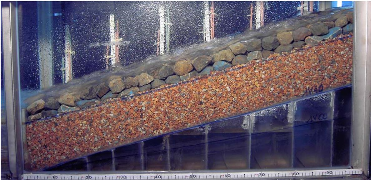
Figura 4.29 materiale di base M2, strato superficiale B1-B5,  $Q=4\text{l/s}$  (prova n°55)
