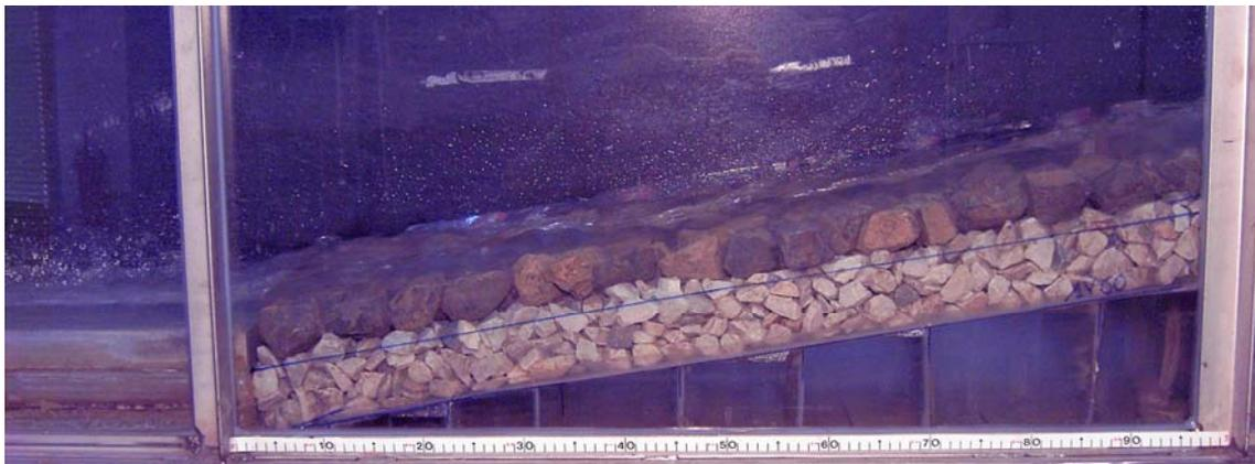
Figura 4.32 materiale di base B2, strato superficiale B6,  $Q=13l/s$  (prova n°95)
