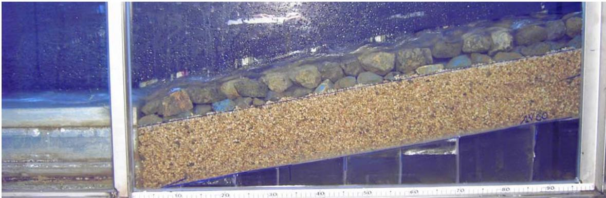
Figura 4. 26 materiale di base M3, strato superficiale B1 - B6,  $Q=4\text{l/s}$  (prova n°78)
