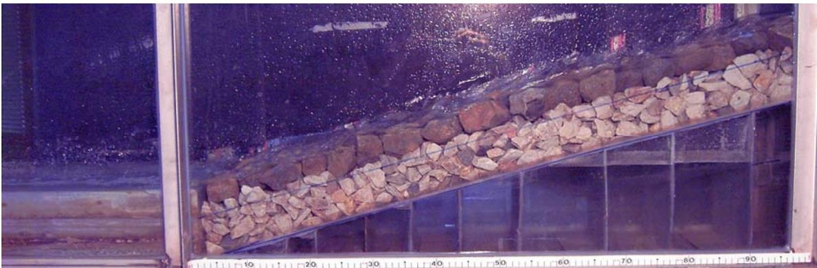
Figura 36 materiale di base B2, strato superficiale, B6,  $Q=4\text{l/s}$  (prova n°105)
