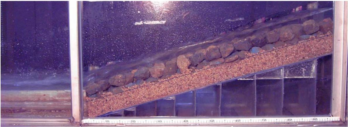
Figura 4.35 materiale di base M3 strato superficiale B1-B6,  $Q=12\text{l/s}$  (prova n°104)
