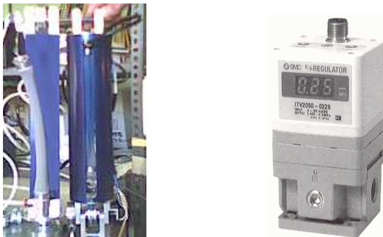
Figura 1.8: Alloggiamento dei muscoli e regolatori elettropneumatici.
