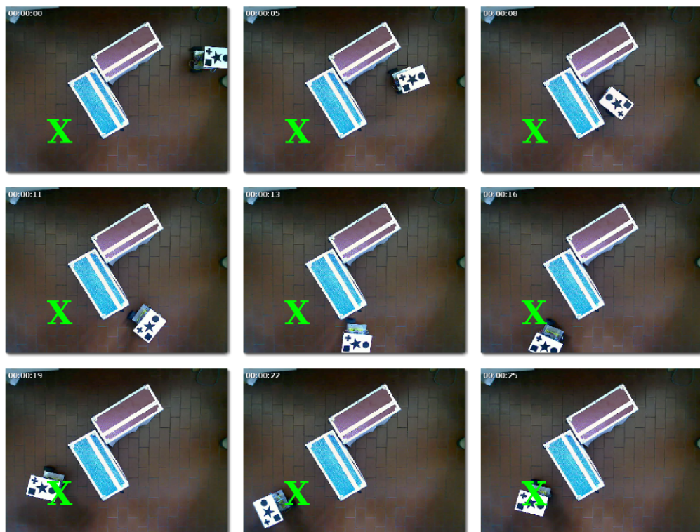
Figura 6.2: Test del RaIN2 in ambiente con presenza di ostacoli. L'ordine della sequenza temporale delle immagini è da sinistra verso destra e dall'alto verso il basso.
