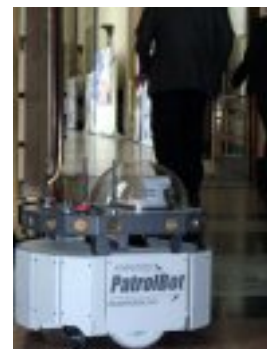
(c) Mobile Robot. HVAC, robot per la sorveglianza di ambienti.
