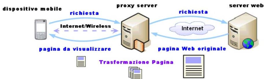
Figura 5.1: Prototipo di sistema basato su architettura proxy server
