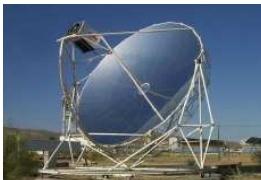
Figura 31 concentratore parabolico (parabolic dish)
