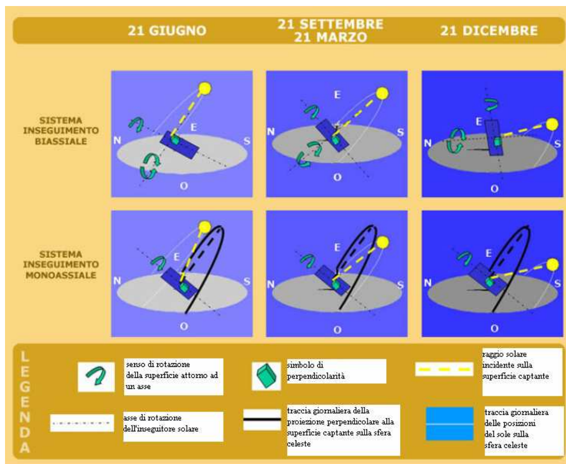
Figura 52 traiettoria solare e inseguimento solare monoassiale e biassiale (fonte: http://www.anu.edu.au/ )
