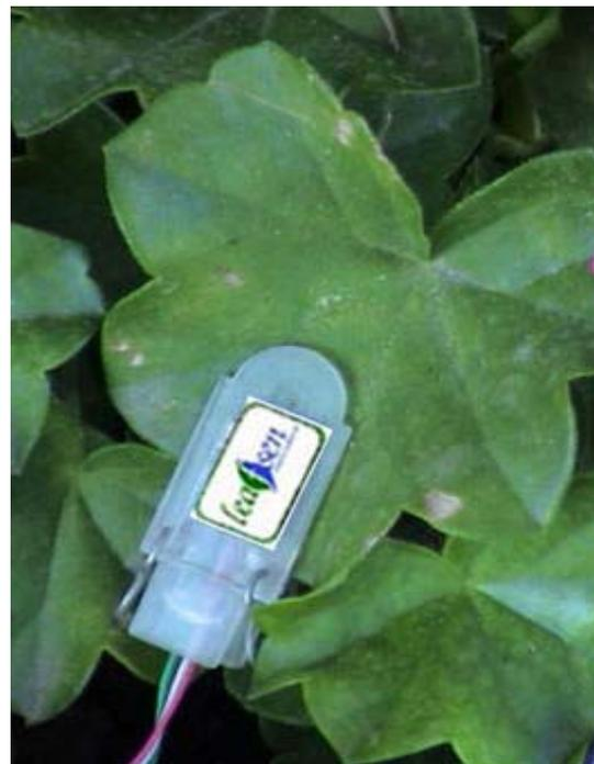
**Sistemi in grado di rilevare un deficit idrico misurando il turgore cellulare**
