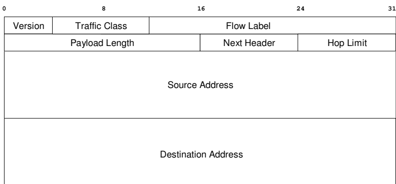
Figura A.2 – Formato dell'header IPv6
