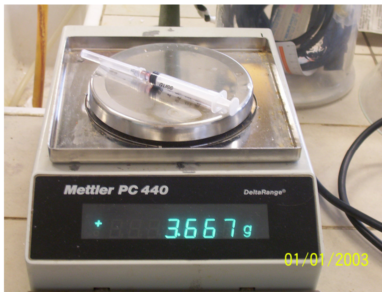
Figura 9: pesatura della siringa dopo l'inoculazione dello ioexolo
