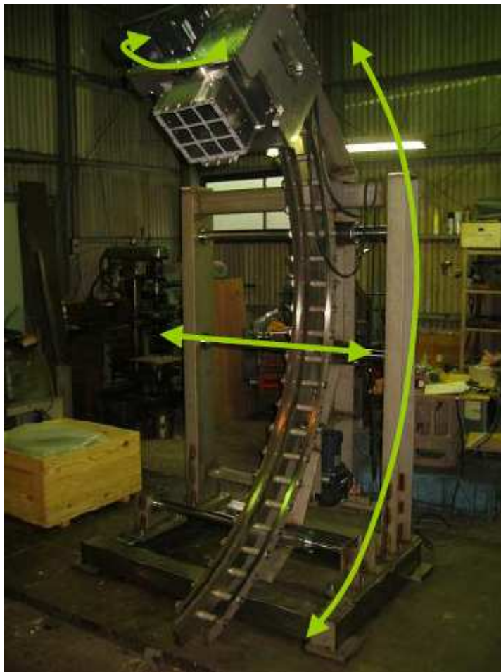
Figura 5.11: Supporto mobile per lo spostamento del calorimetro ausiliare di NaI
