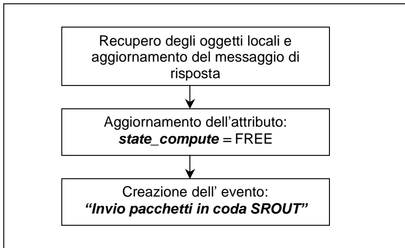
Figura 3.28 Diagramma di flusso dell'evento "Richiesta risposte locali secondo l'algoritmo R1"
