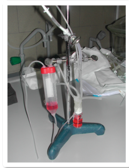
Figura 4-6: Camera di recupero schiuma collegata.
