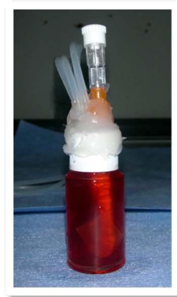
Figura 4-4: La nuova camera di miscelazione durante i test con terreno di coltura.
