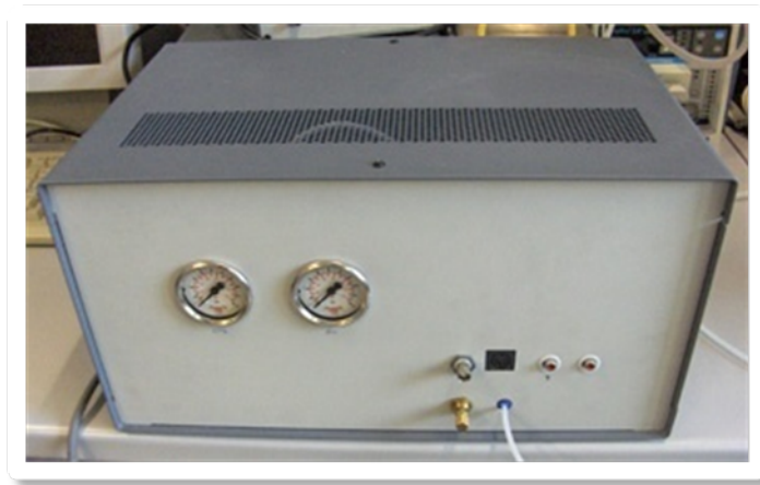
Figura 3-4: Hardware controllo elettrovalvole e lettura sensori.
