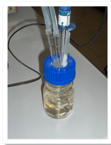
Figura 3-1: La camera di miscelazione.
