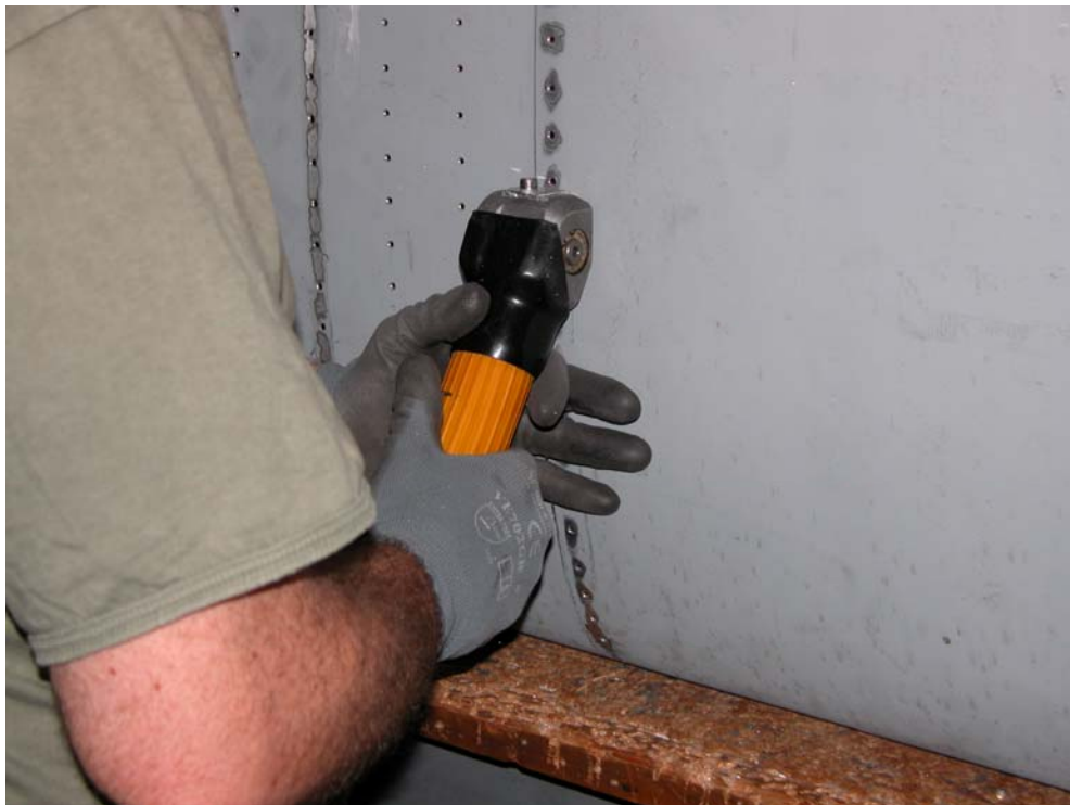
Figura 107. Taglio del bordo d'attacco con flessibile pneumatico.
