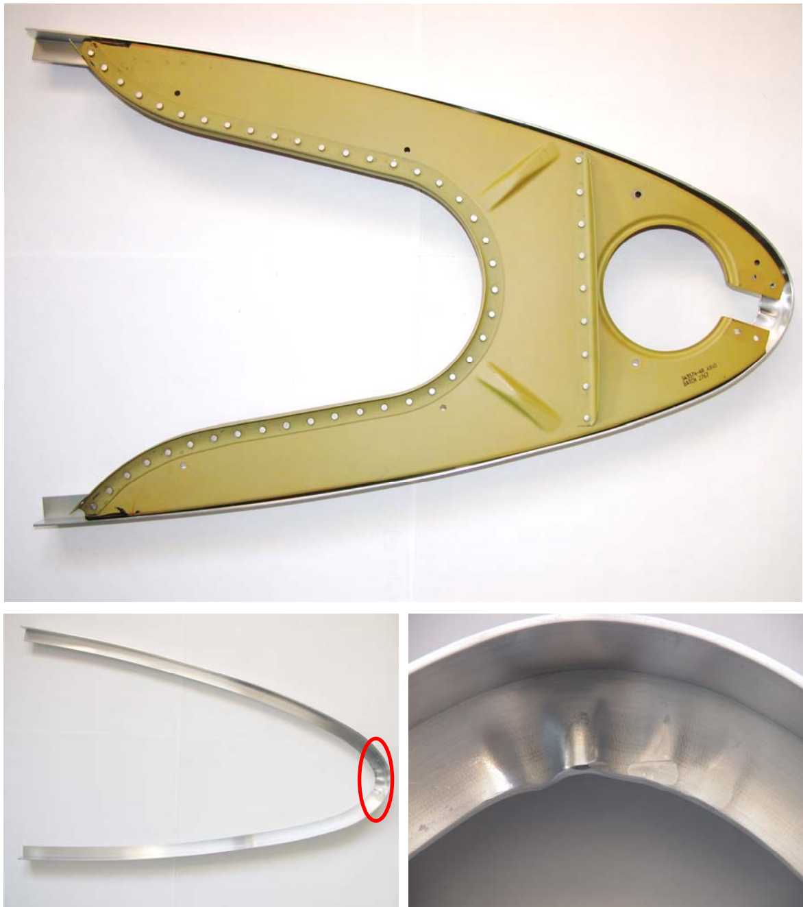
Figura 71. Profilo ottenuto con alluminio commerciale 6060.
