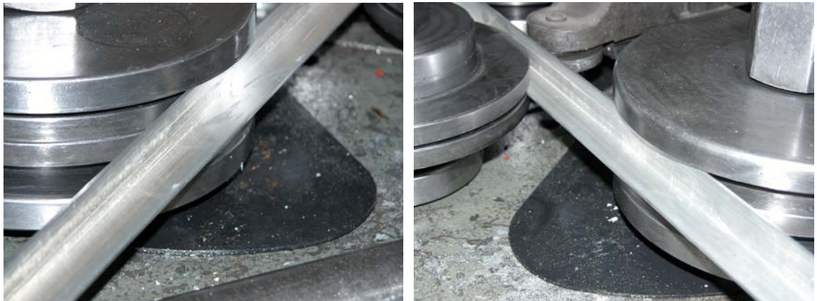
Figura 69. Disposizione dell'estruso sulla curvatrice.
