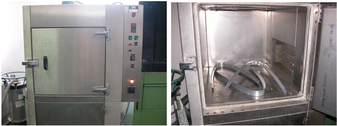
Figura 76. Forno a ricircolo di aria calda utilizzato per l'asciugatura dei pezzi.
