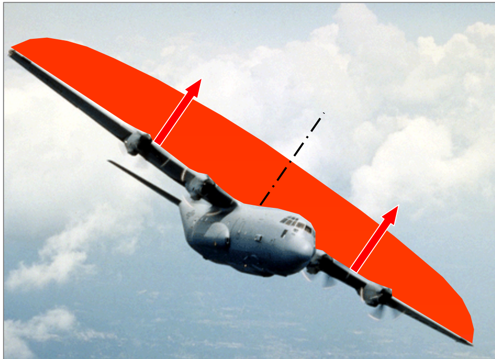
Figura 41. Andamento ellittico della distribuzione di portanza.
