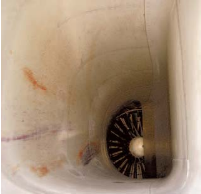
Figura 15. Segni di impatto con volatile nel condotto della presa d'aria del velivolo AMX.
