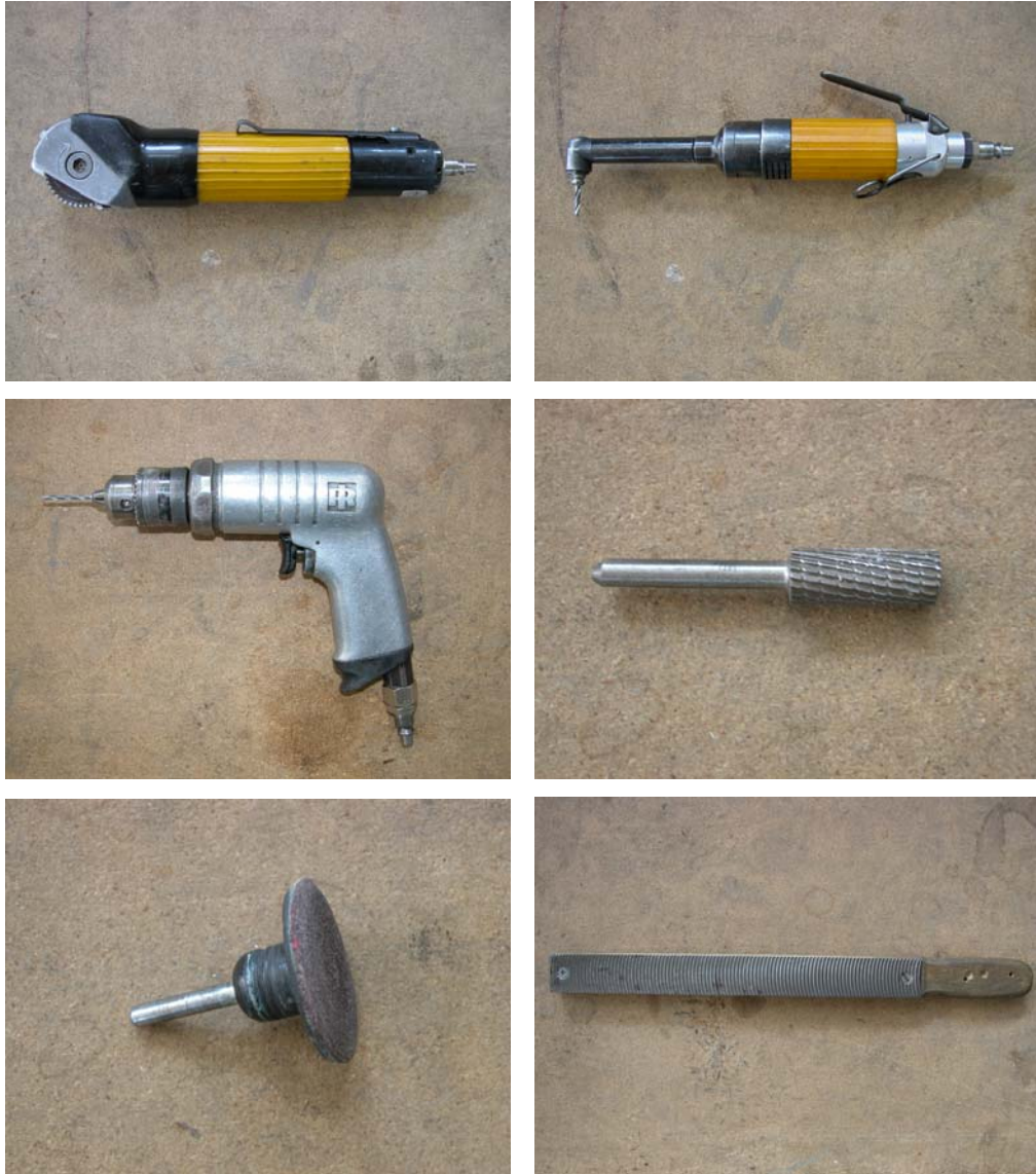
Figura 108. Parte degli strumenti impiegati per la realizzazione del taglio del bordo d'attacco e per la realizzazione dei forni necessari all'installazione delle viti e dei ribattini.
