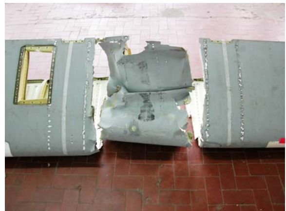
Figura 34. Vista esterna della sezione danneggiata.
