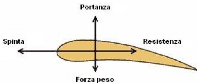
Figura 20. Forze aerodinamiche sul profilo alare.
