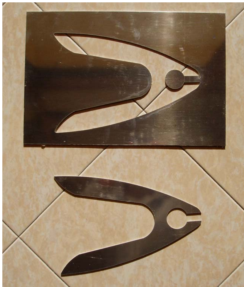
Figura 103. Lamiera di alluminio 2024 tagliata con tecnica Water Jet.
