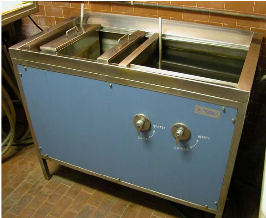
Figura 88. Vasca contenente il rivelatore che consente lo sviluppo pellicola radiografica.
