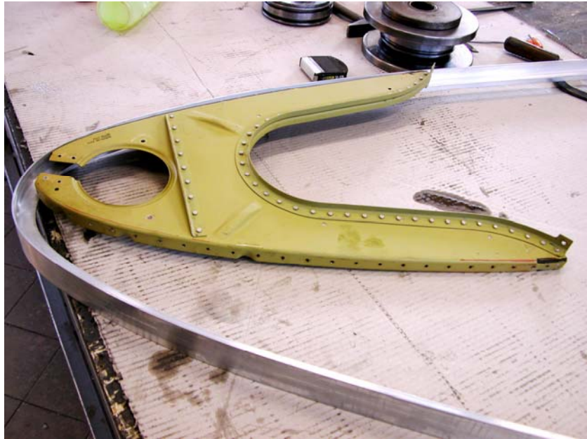
Figura 67. Confronto tra il minimo raggio di curvatura ottenibile e quello da realizzare.
