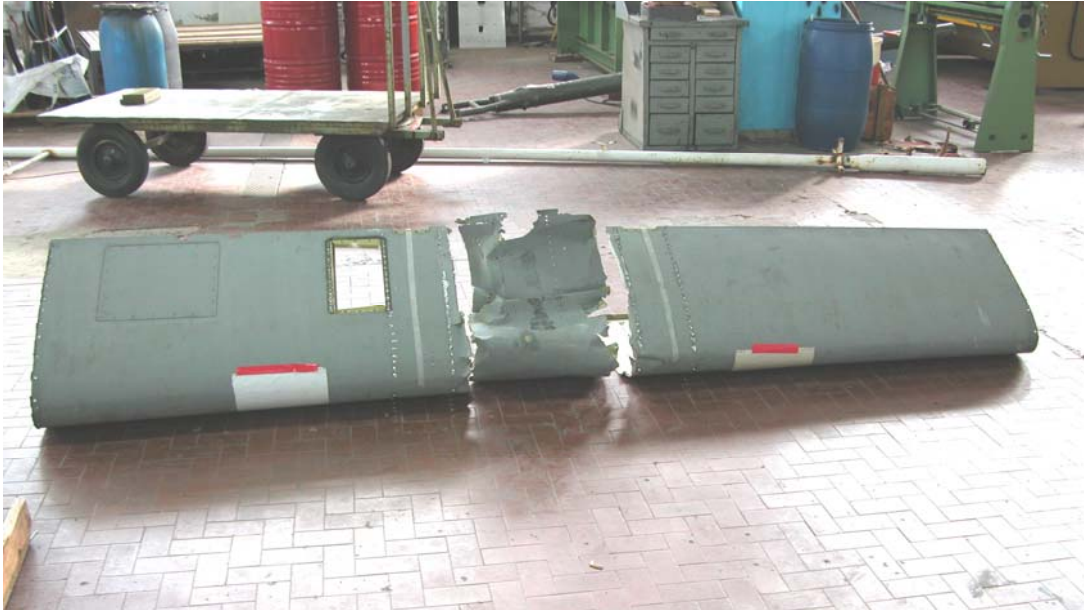
Figura 32. Bordo d'attacco danneggiato.
