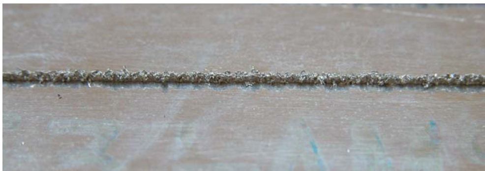
Figura 106. Superficie craterizzata del campione di alluminio 2024 su cui è stato realizzato il taglio laser.
