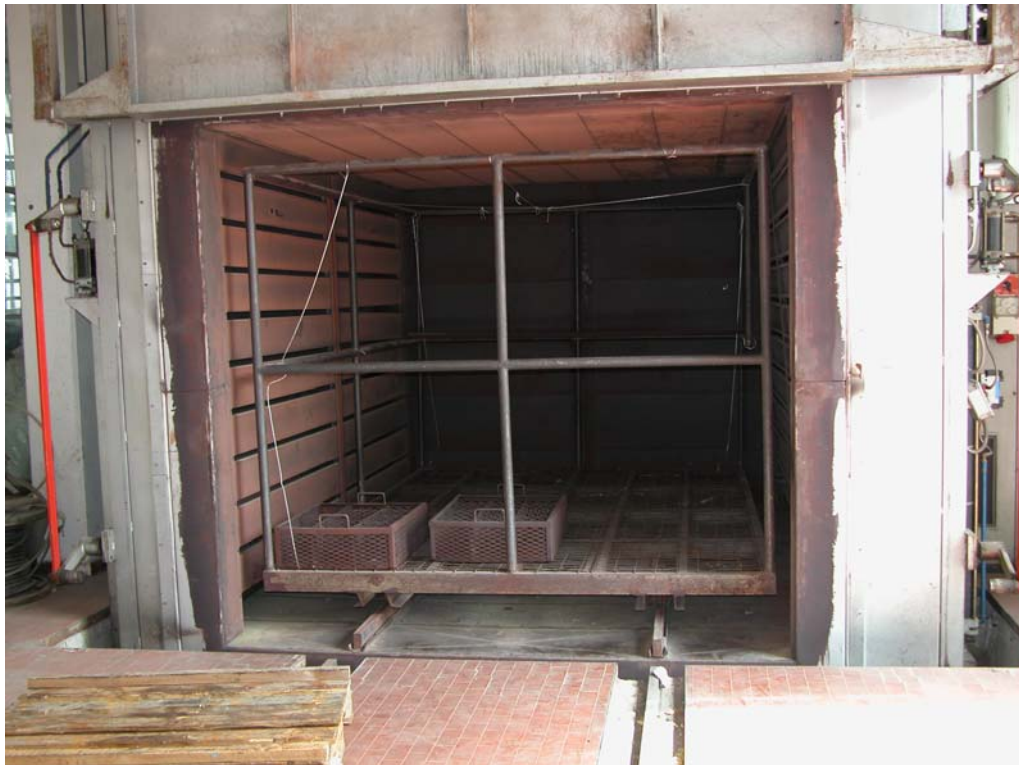
Figura 97. Forno impiegato per il processo di solubilizzazione e invecchiamento artificiale.
