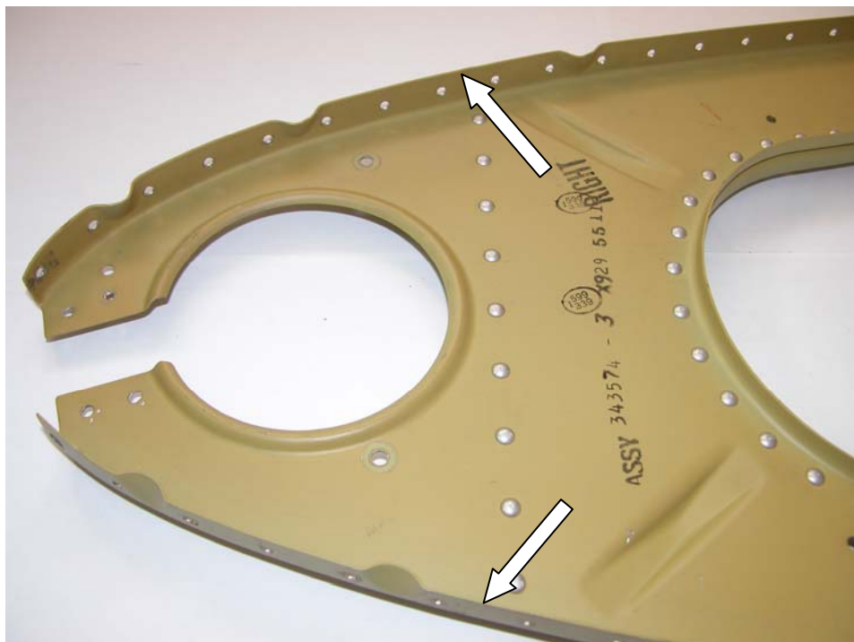
Figura 109. Bordo piegato della centina che ne permette il collegamento allo skin.
