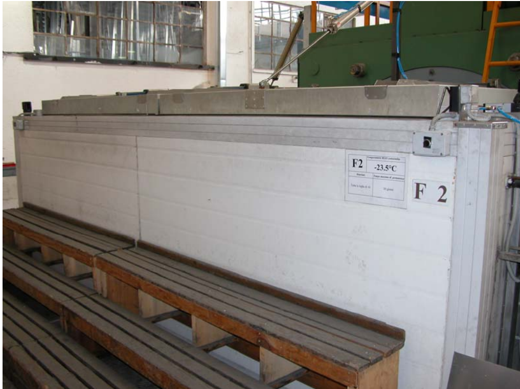
Figura 93. Frigo per la refrigerazione del materiale subito dopo la tempra.
