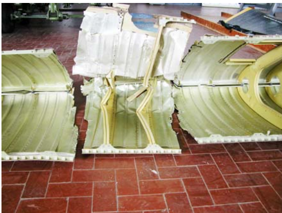
Figura 33. Vista interna della sezione danneggiata.
