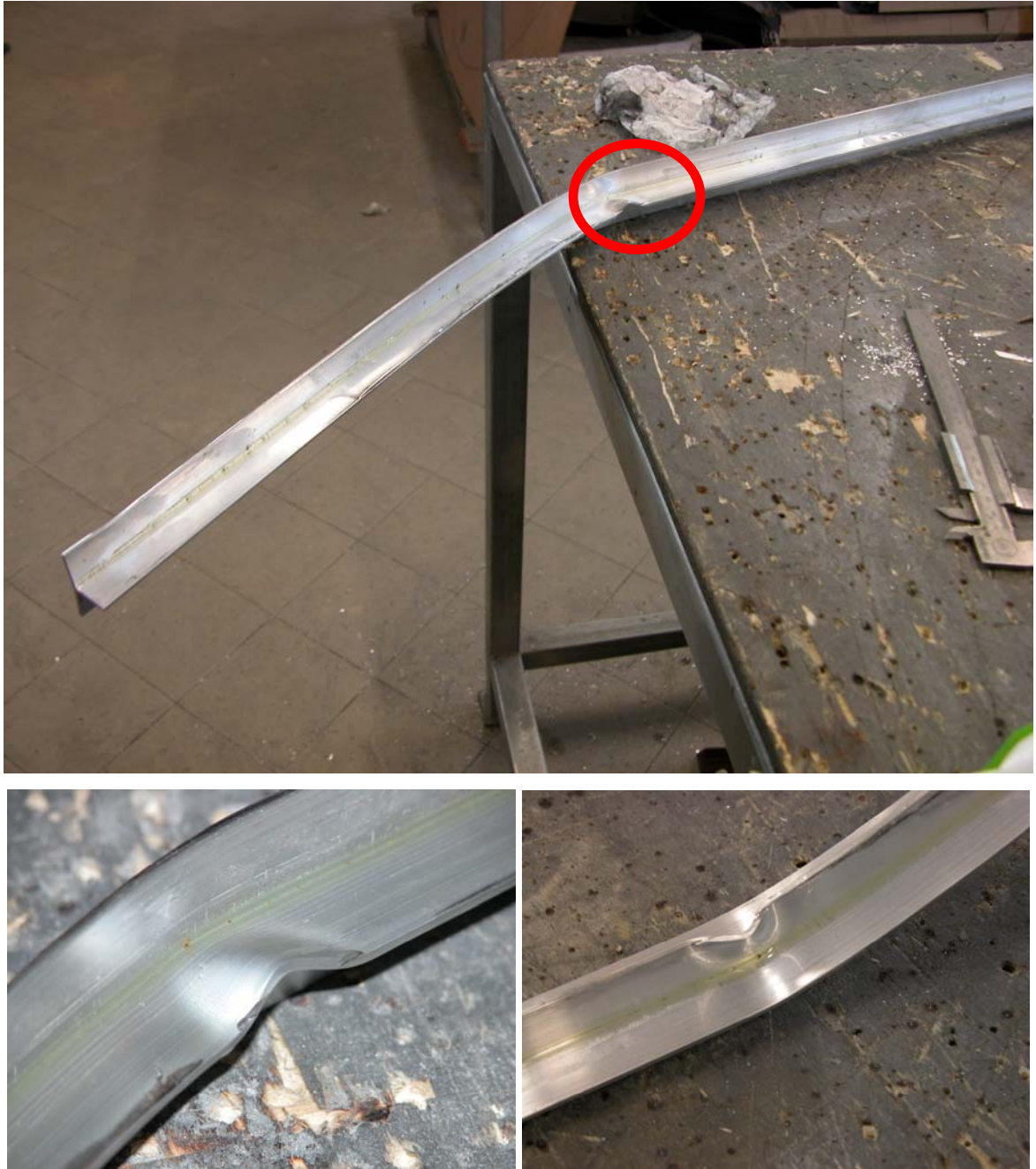
Figura 70. Imbozzamento dell'anima centrale.
