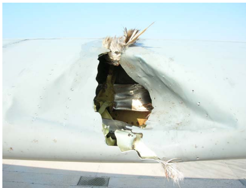
Figura 17. Bordo d'attacco del C-130J a seguito di impatto con volatile.
