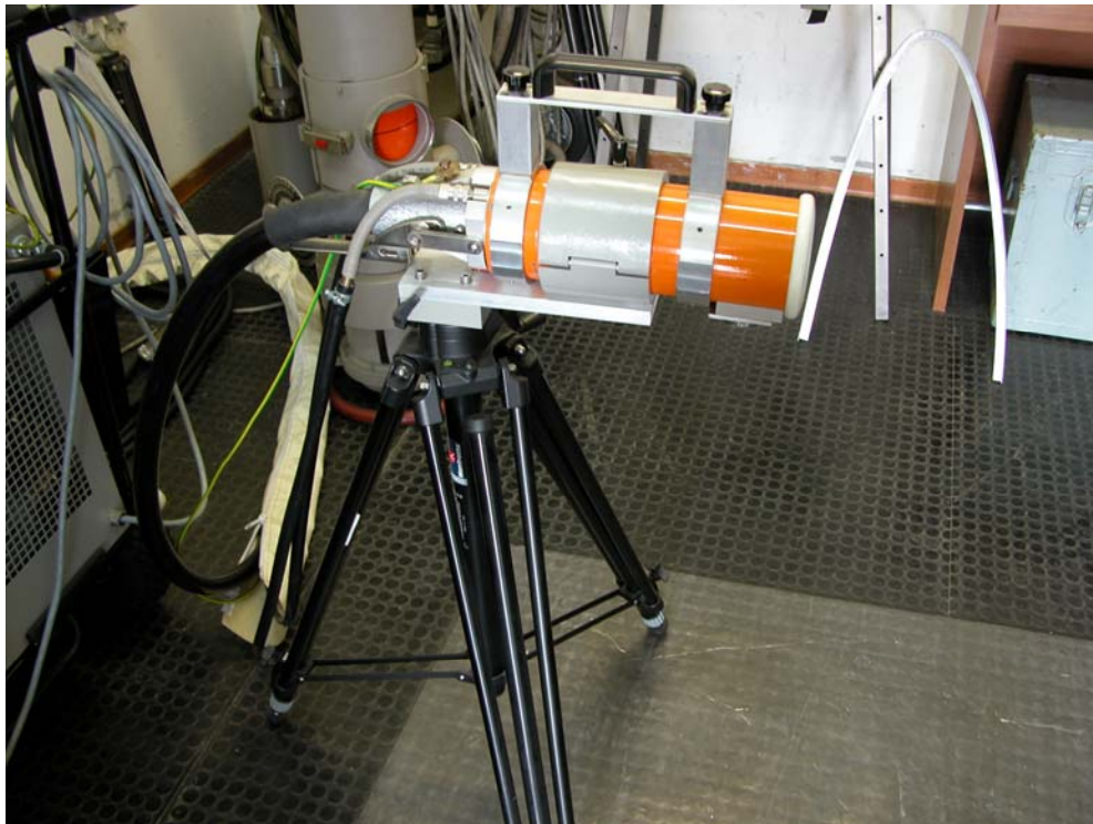
Figura 84. Unità a raggi X impiegata per il controllo non distruttivo con tecnica radiografica.
