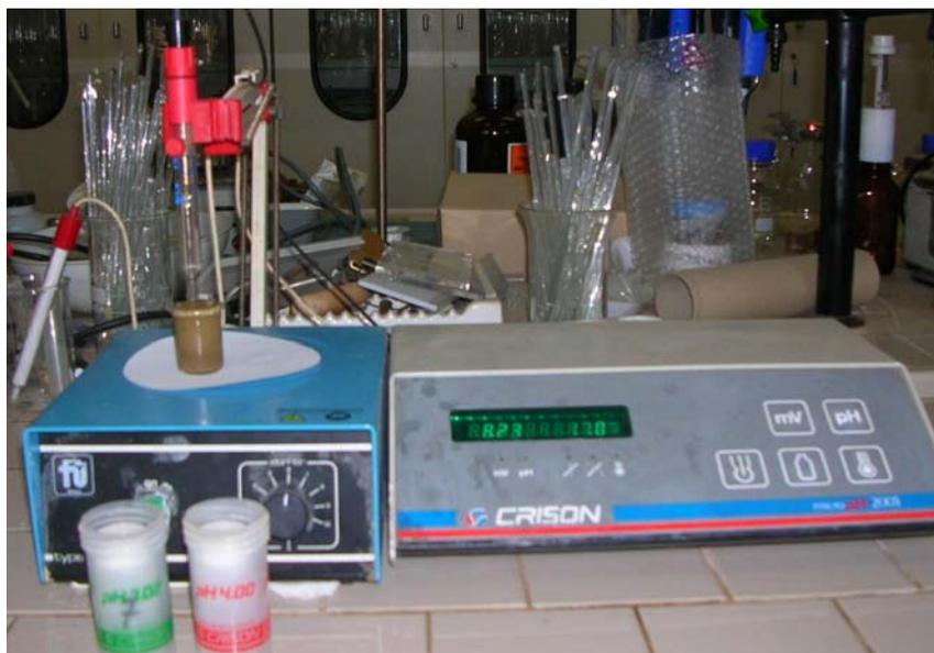
Figura 2.6 – Determinazione del pH per via potenziometrica.
