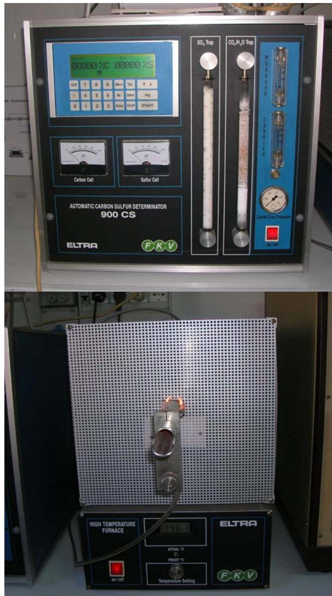
Figura 2.7 – Analizzatore ad infrarossi ELTRA CS per la determinazione del carbonio organico totale e particolare del forno per la combustione.
