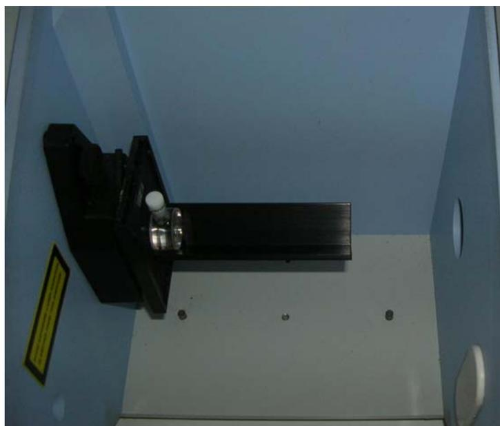
Figura 2.5 – Particolare dello spettrometro all'infrarosso e cuvetta utilizzata per l'analisi degli idrocarburi.
