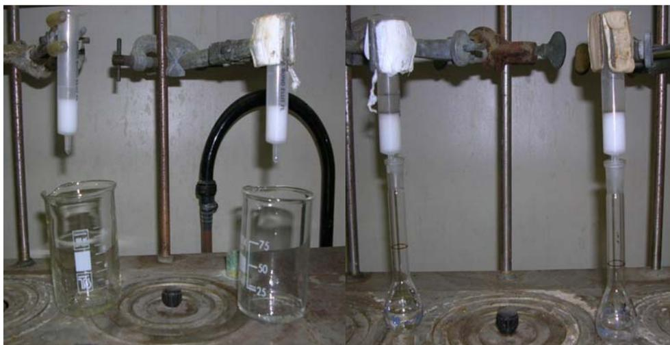
Figura 2.3 – Attivazione delle colonne di "Florisil" e raccolta del campione per l'analisi degli idrocarburi.
