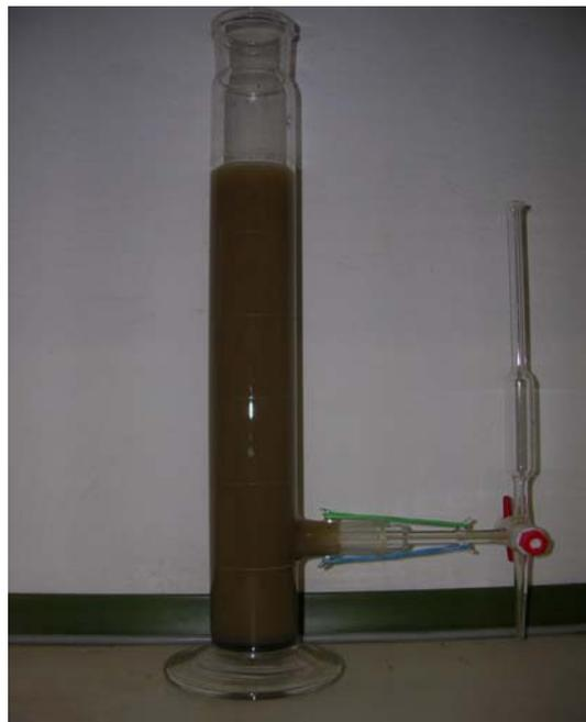
Figura 2.2 – Levigatore di Esenwein per l’analisi della tessitura.
