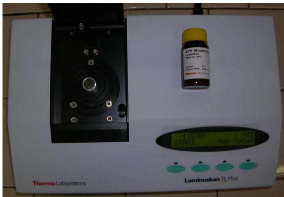
Figura 2.12 – Luminometro utilizzato per la determinazione dell'ATP.
