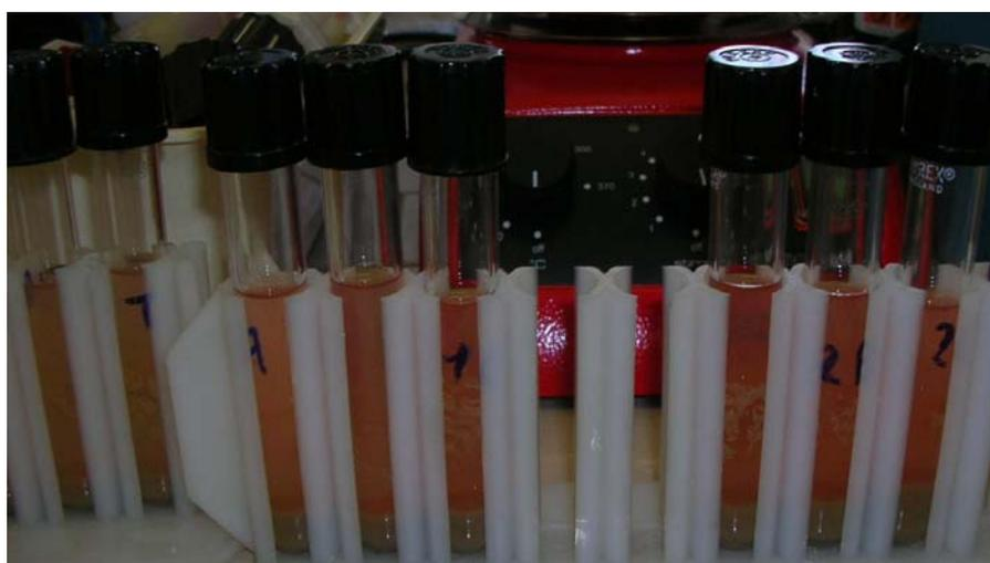
Figura 2.9 – Soluzione prodotta dopo l'aggiunta di metanolo ai campioni utilizzati per la determinazione dell'attività deidrogenasica; le differenze di colore corrispondono alle diverse concentrazioni di 2,3,5 trifenilformazano (TPF).
