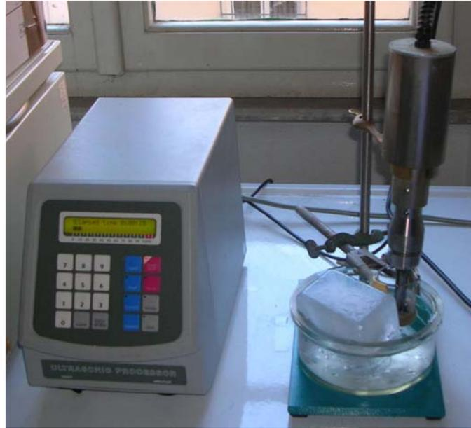
Figura 2.11 – Ultrasonic processor utilizzato per sonicare i campioni in bagno di ghiaccio per la determinazione dell'ATP.
