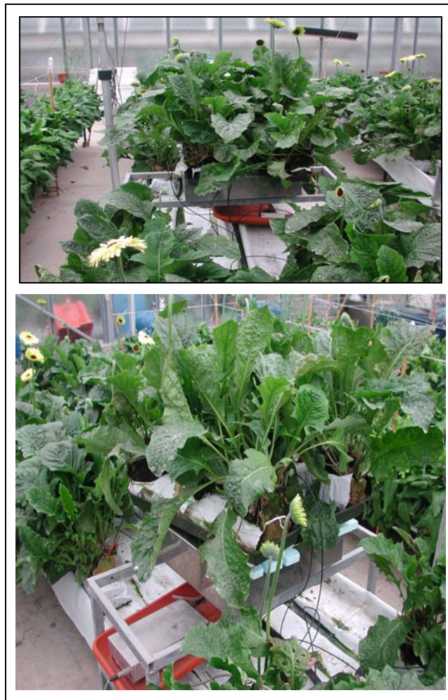
Particolare di piante di gerbera su bilancia elettronica (microlisimetro gravimetrico)
