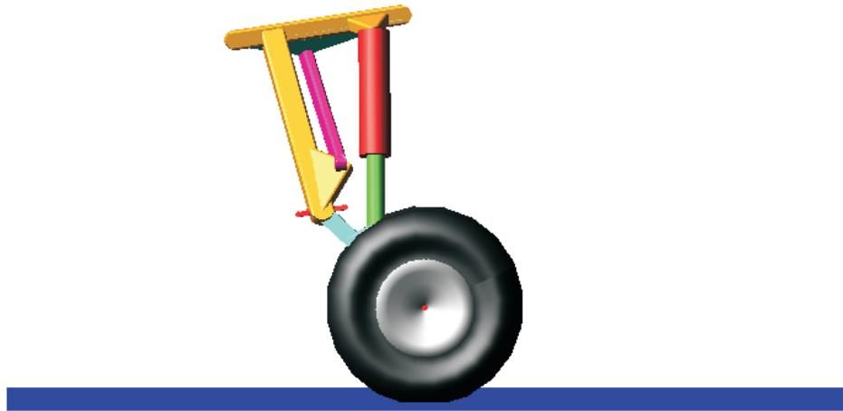
Figura 6.2 Modello del carrello elastico (main)
