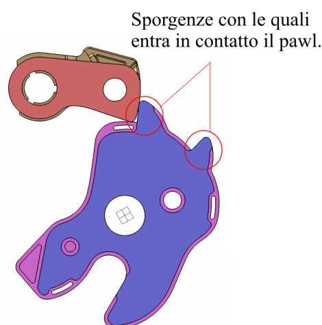
Fig. 2.8: Schema di contatto pawl-ratchet; sporgenze di contatto del ratchet.
