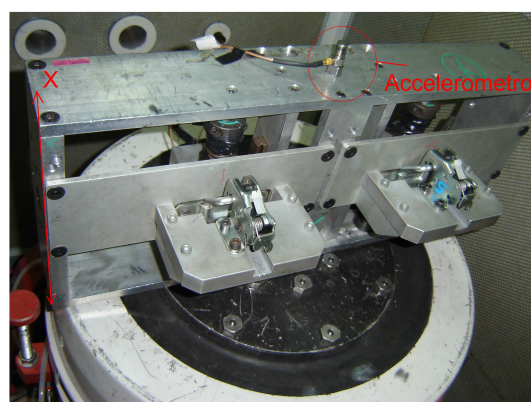
(b) Attrezzatura montata sullo shaker per la prova di vibrazione lungo l'asse X.
