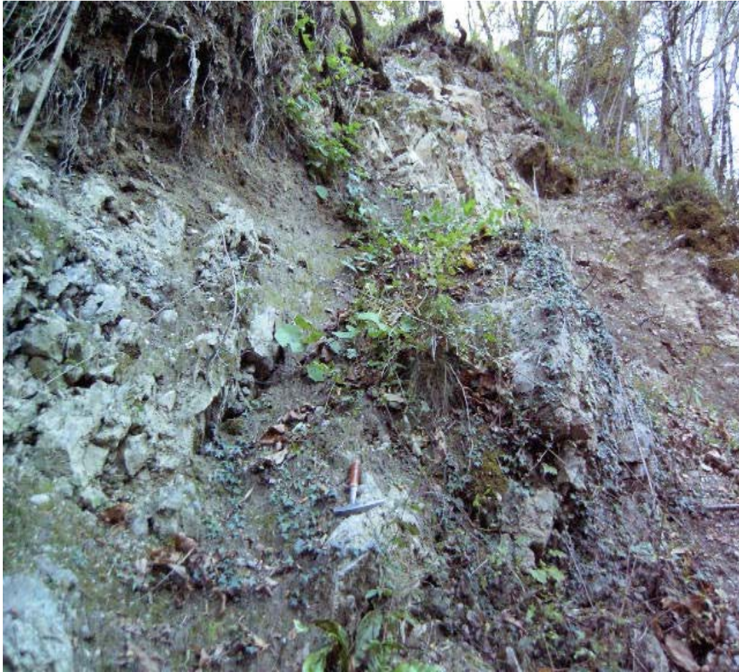
Figura 25-Scorrimento nella zona di Roveta. Lo scorrimento si è impostato sulla roccia (SVL); la instabilità si sviluppa in senso retrogressivo, coinvolgendo le rocce e le coperture in prossimità della corona.
