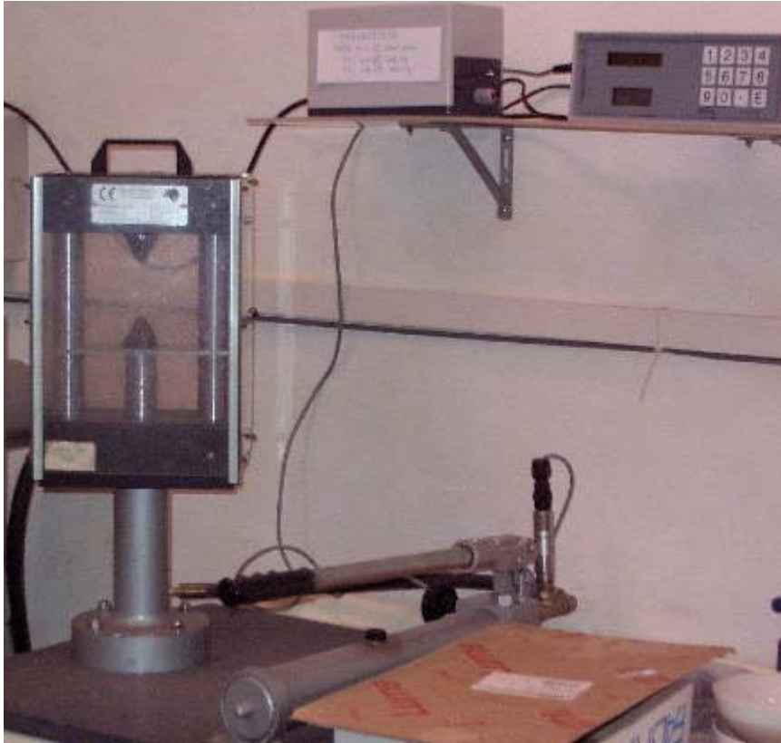
Figura 29- Apparecchio per l'esecuzione del point load test.
