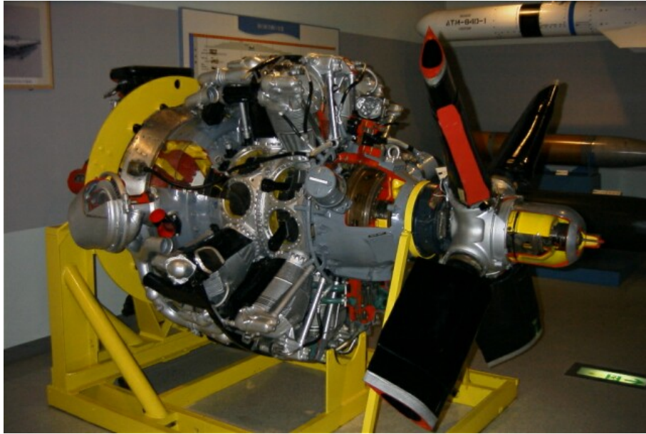
Figura 1.5: Curtiss-Wright R3350 turbocompound [1950]. Cilindrata 54560 \text{ cm}^3 , 18 cilindri a doppia stella raffreddato ad aria sovralimentato con compressore centrifugo a doppio stadio. Alesaggio e corsa 155,6 \times 160,2 \text{ mm} . Potenza al decollo 3700 \text{ hp} @ 2900 rpm.
