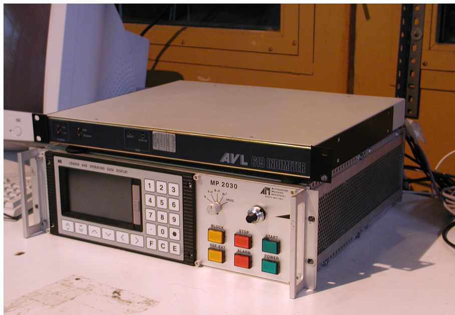
Figura 7.10: Particolare dell'INDIMETER (sopra) e dell'apparecchiatura elettronica di controllo del freno dinamometrico (sotto).
