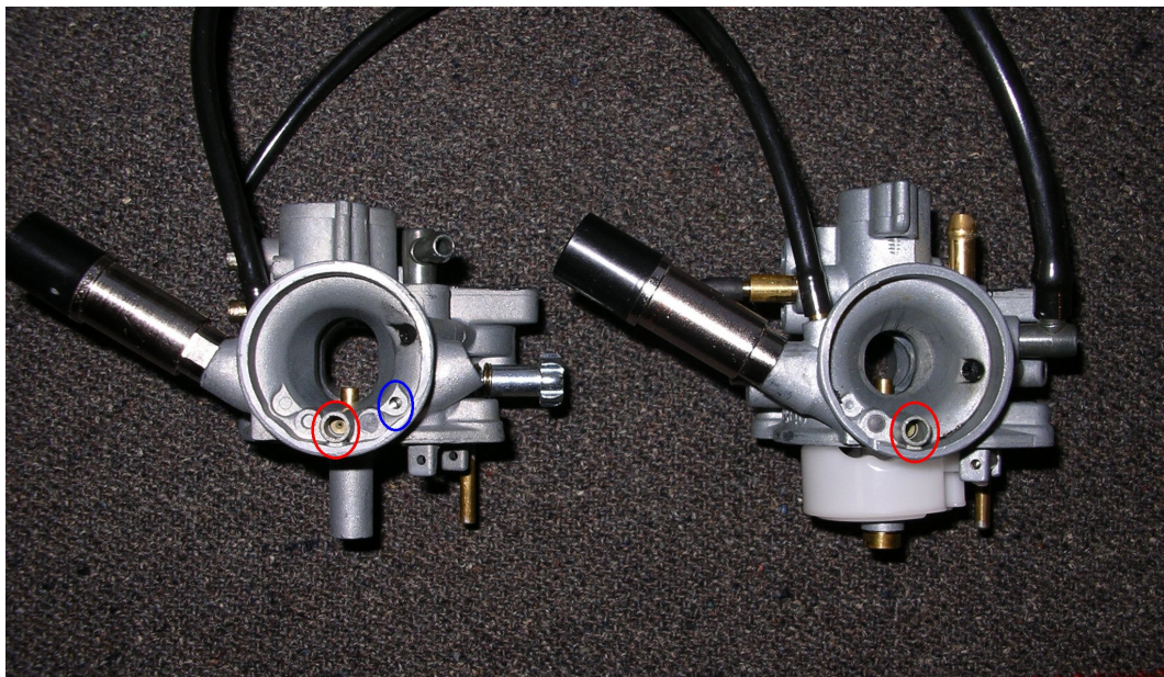
Figura 6.2: Vista dei carburatori parzialmente disassemblati: a sinistra il modello PHVA16, a destra il PHVA12. Evidenziate in rosso abbiamo le zone di ingresso delle arie antagoniste del massimo, in blu il foro di ingresso dell'aria antagonista del minimo presente solo sul PHVA16.
