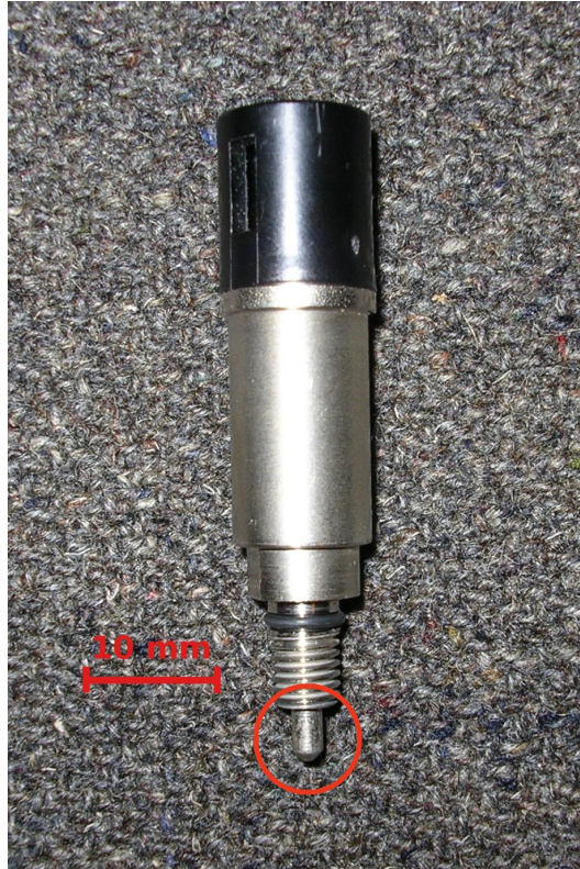
Figura 6.4: Vista del solenoide: in evidenza la valvola cilindrica che intercetta il circuito dell'aria di diluizione.
