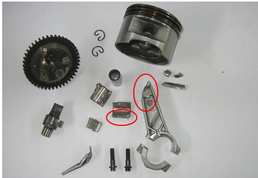
Figura 8.25: Insieme dei particolari danneggiati in seguito alla rottura della biella. In evidenza le zone sottoposte all'analisi al microscopio elettronico.
