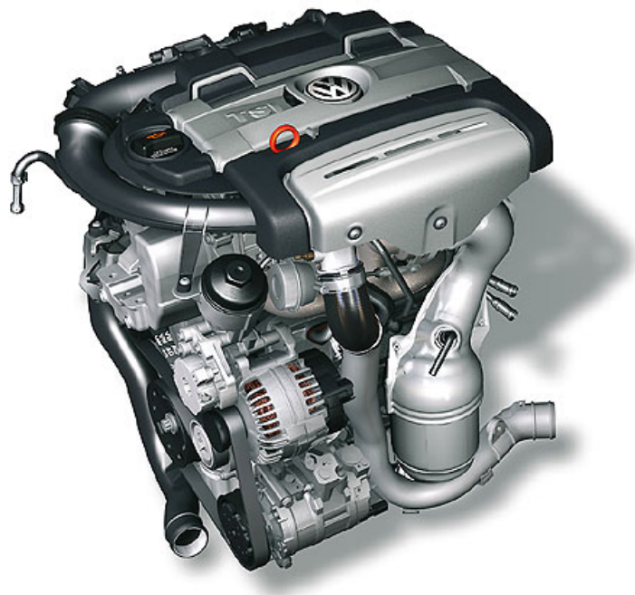
Figura 1.4: Volkswagen TSI Twincharger [2005]. Cilindrata 1400\text{ cm}^3 , 4 cilindri in linea ad iniezione diretta di carburante. Sovralimentato con compressore volumetrico ad azionamento meccanico + turbocompressore a gas di scarico. Potenza max 170\text{ cv} @ 6000 giri/min; coppia 240\text{ Nm} @ 1750–4500 giri/min.
