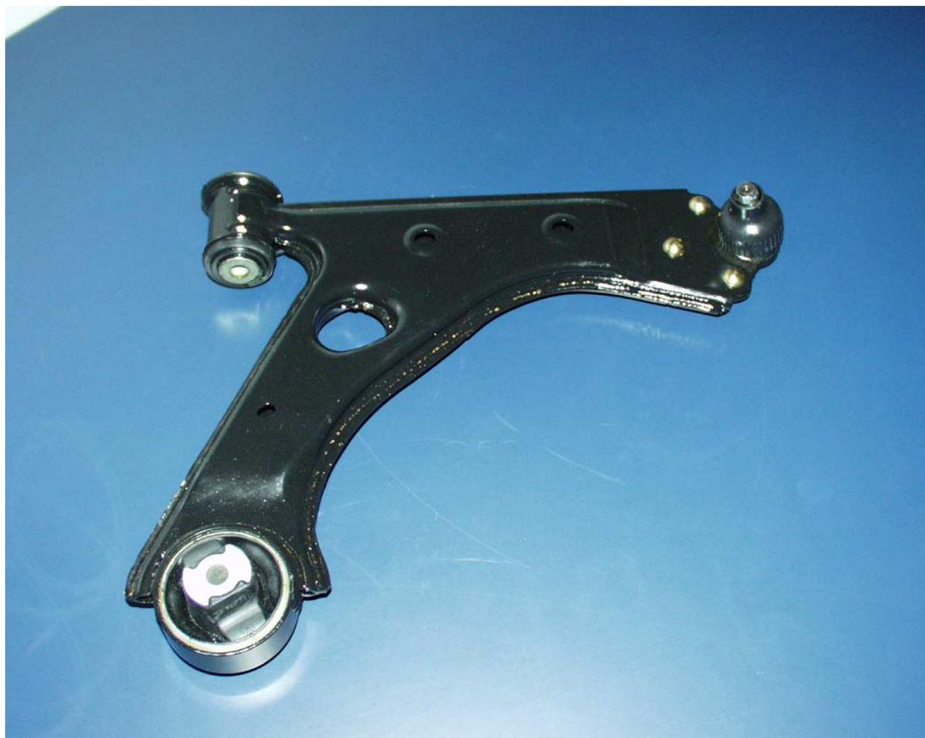
Figura 1.5: Braccio sospensione Magneti Marelli Holding S.p.A.
