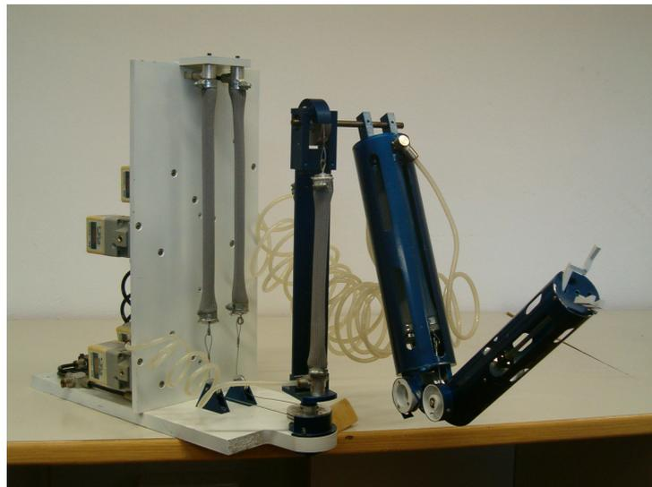
Figura 3.9: Il braccio robotico UNIFI Softarm, costruito presso il Centro Interdipartimentale di Ricerca "E. Piaggio", è equipaggiato con dei muscoli artificiali di McKibben.
