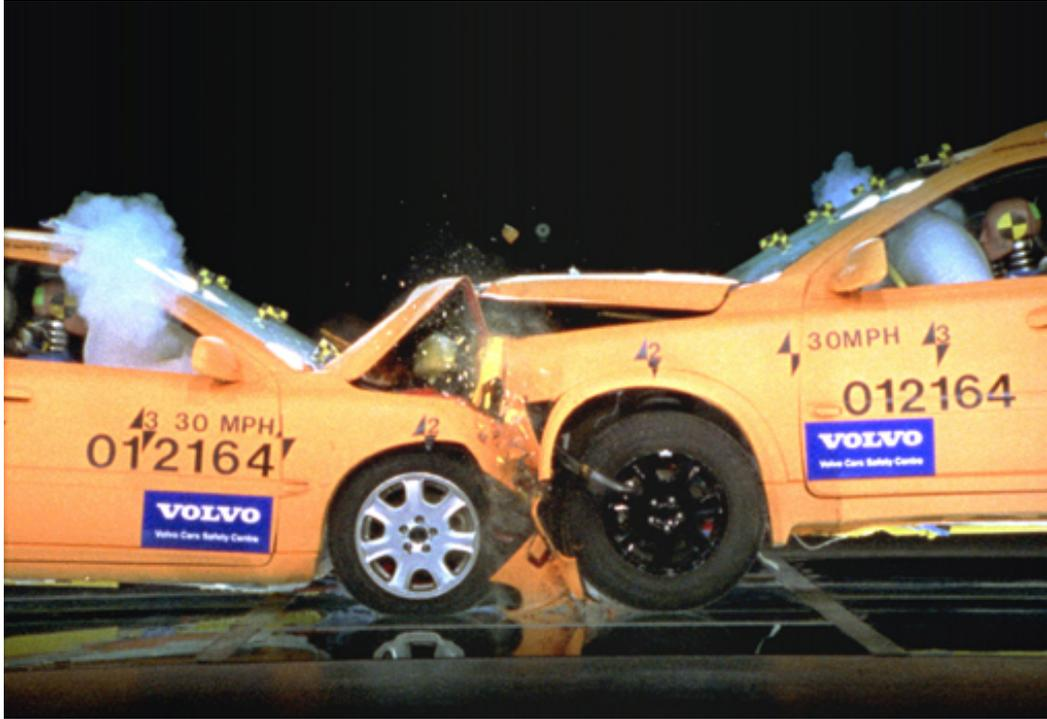
Figura 1.9: Immagine ripresa da un crash-test tra due automobili in cui vengono utilizzati i famosi “*dummies*” della serie Hybrid III.
