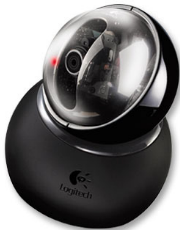
Figura 5.10: La telecamera Logitech QuickCam® Orbit , usata per rilevare la posizione del bersaglio.
