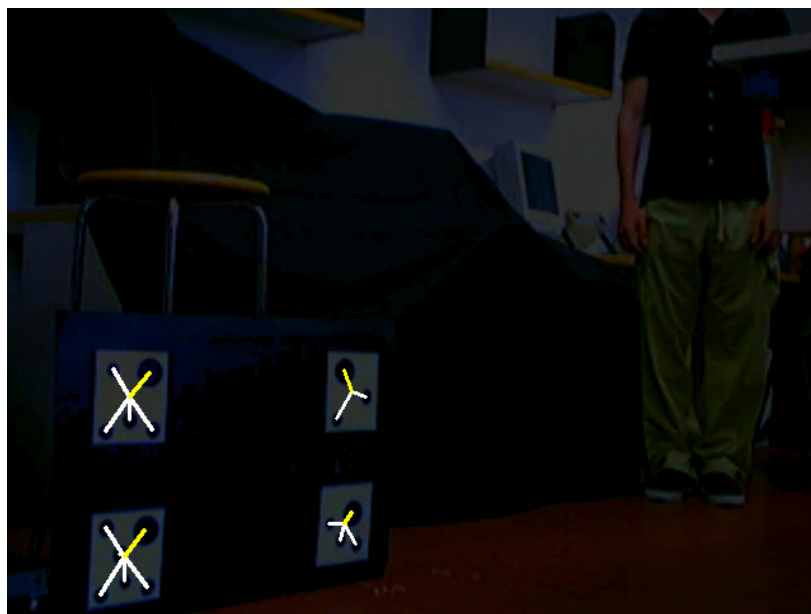
Figura 3.4: L'immagine vista durante la calibrazione, nel caso in cui i marcatori siano disposti su un piano non ortogonale alla visuale della telecamera.
