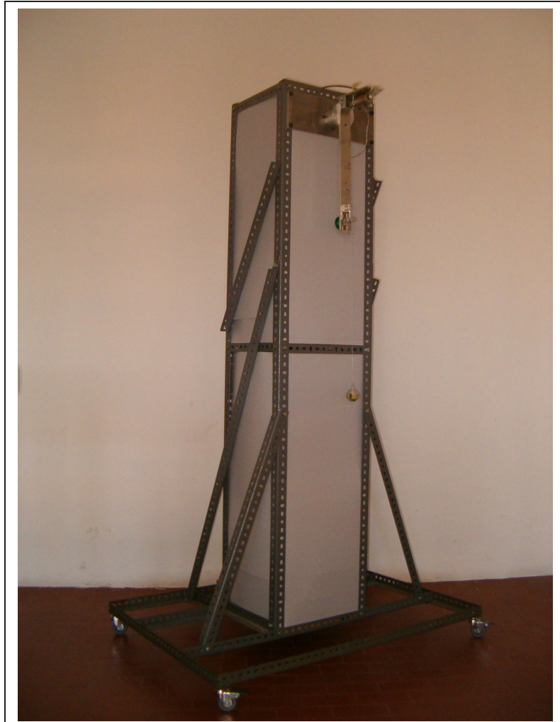
Figura 5.1: Il manipolatore del lancio costruito in laboratorio per la verifica dei risultati sperimentali.
