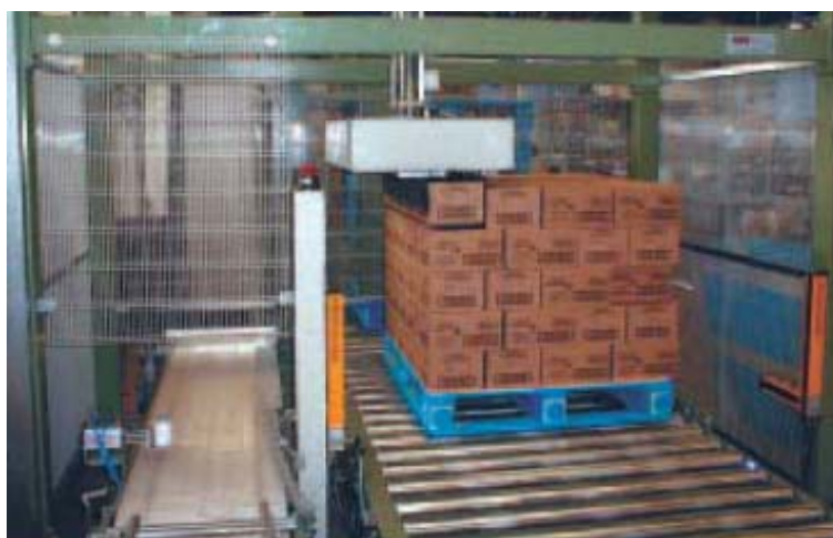
Figura 1.1: pallettizzatore cartesiano o a portale
