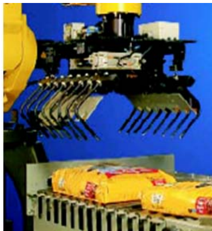
Figura 1.6: pinze di prelievo a forca
