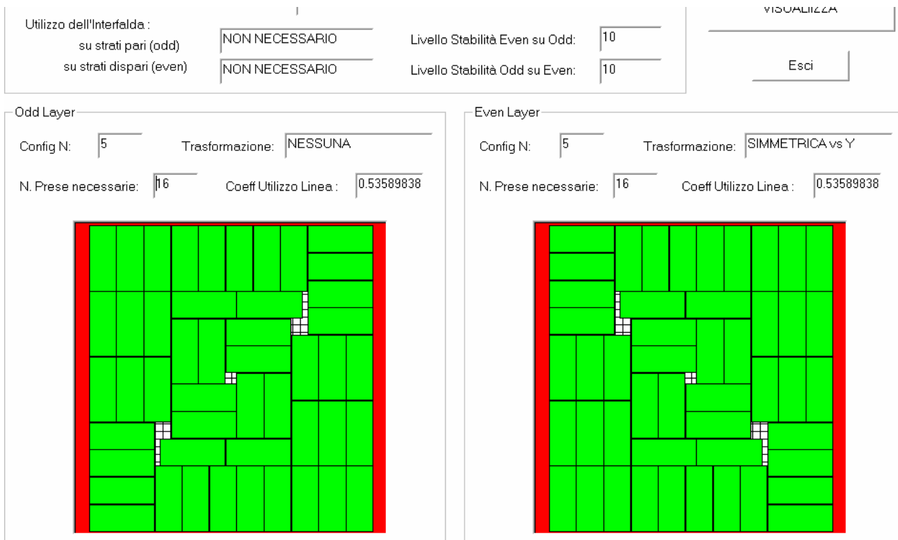
Figura 6.2: istanza [560,520,120,50]; ulteriore soluzione trovata da PALLETTIZZA
