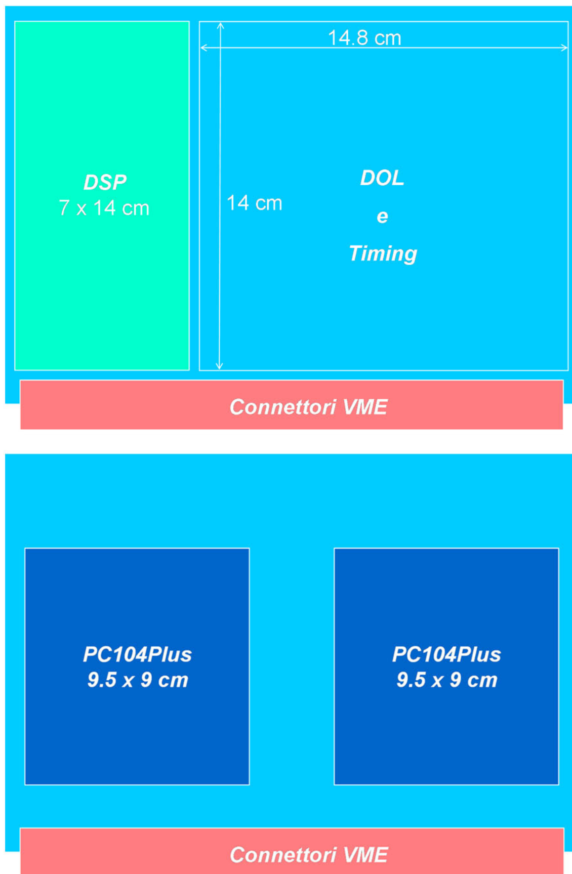
Figura 5.2: Scheda madre in formato VME che ospiterà gran parte dei componenti del controllo locale
